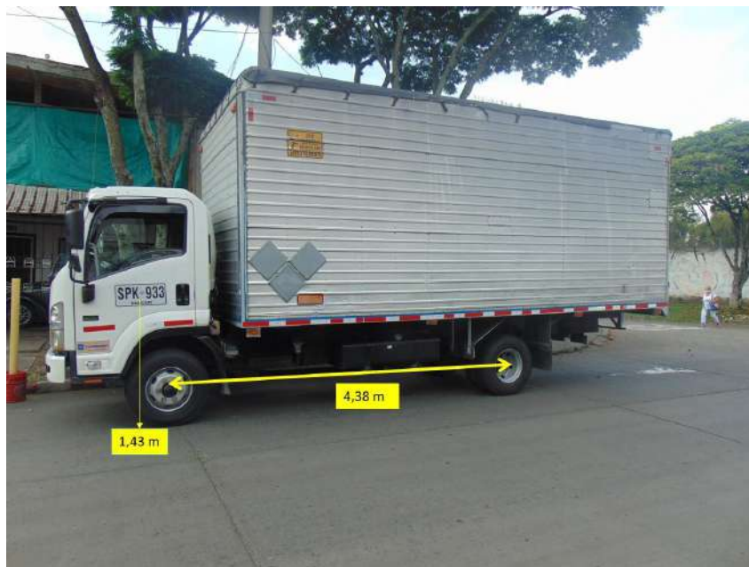
FOTOGRAFÍA No. 10 PLANO GENERAL : En esta fotografía se observa la distancia entre ejes y la altura del piso a la zona del asiento del conductor.
