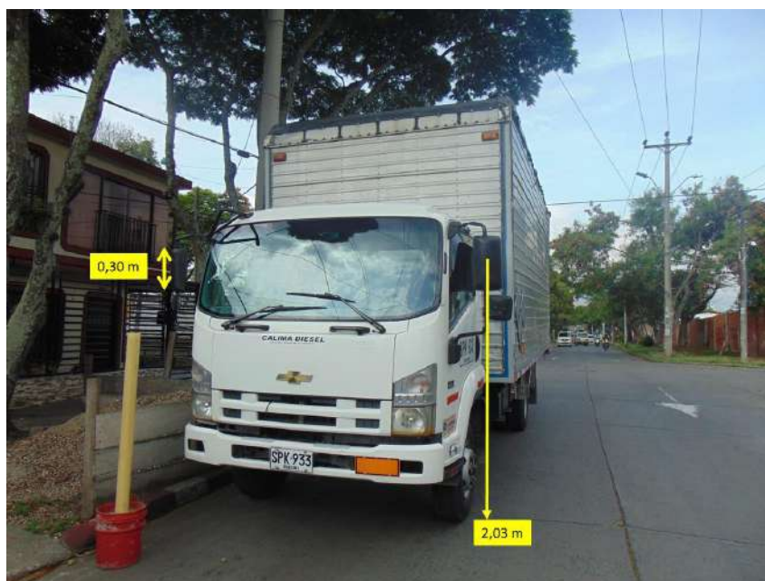
FOTOGRAFÍA No. 11 PLANO GENERAL : En esta fotografía se aprecia la altura de los espejos respecto al suelo y su dimensión.
