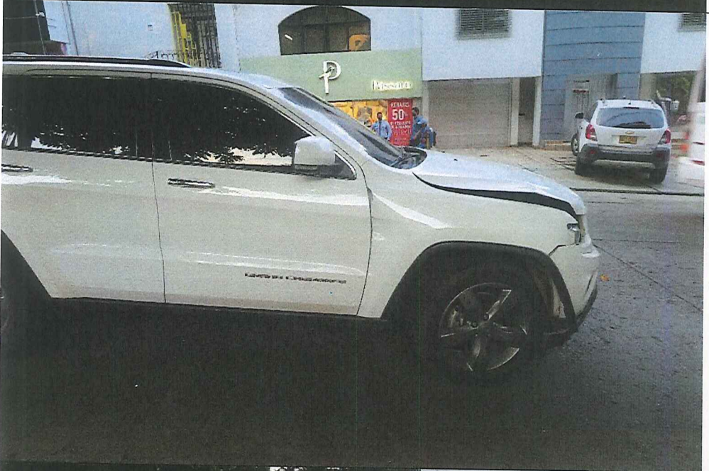
IMAGEN No. 14: PRIMER PLANO , donde se observa el lado derecho delantero del campero implicado con abolladuras en guardafango y capot.
