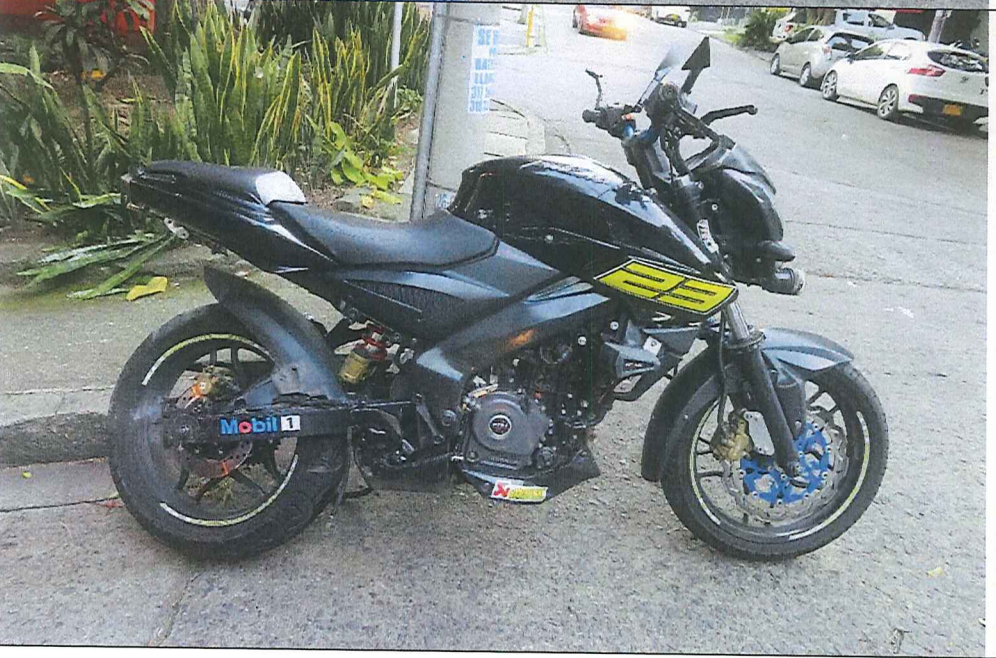
IMAGEN No. 24: PRIMER PLANO , donde se observa el lado derecho de la motocicleta implicada y sus deformaciones.
