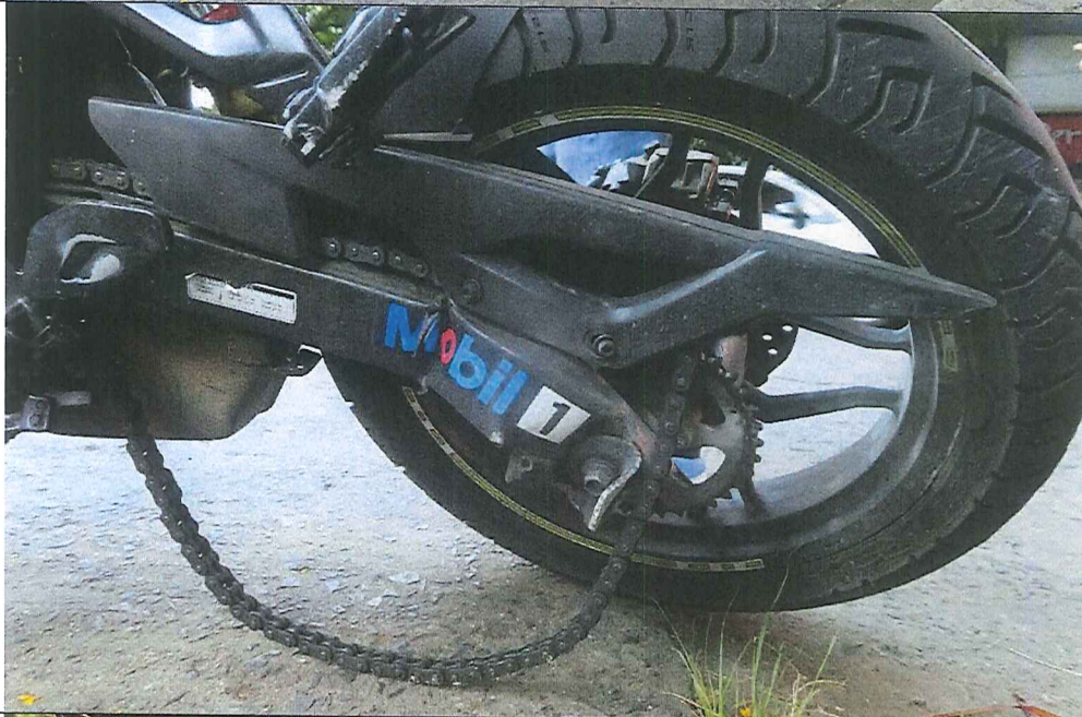
IMAGEN No. 20: PRIMERISIMO PLANO , donde se observa abolladura en tijera lado izquierdo trasero de la motocicleta implicada (punto de impacto con el sardinel).
