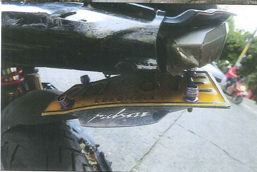
IMAGEN No. 18: PRIMERISIMO PLANO , donde se observa abolladuras y roturas en placa (UGP67E) y tapa superior trasera de la motocicleta implicada.
