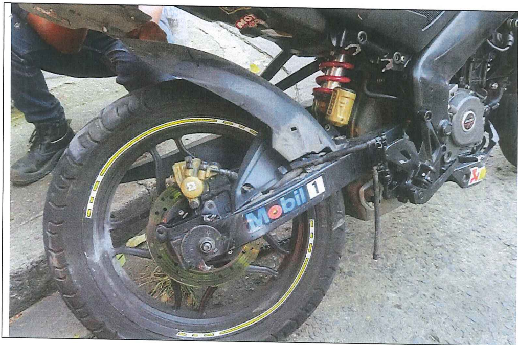
IMAGEN No. 25: PRIMERISIMO PLANO, donde se observa deformación en aro y rotura guardafango trasero (punto de colisión).
