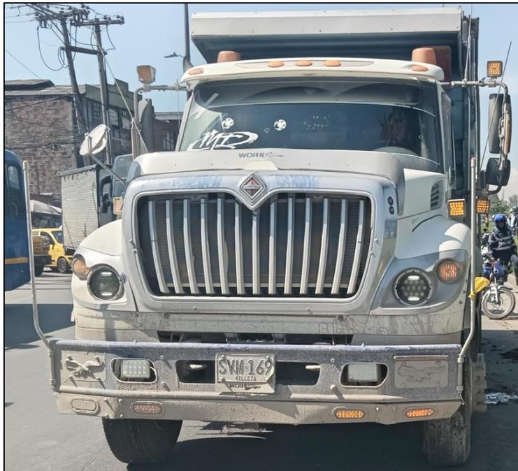
**Fotografías No. 6 y 7:** En estas fotografías se aprecia el estado final de la zona frontal de la volqueta, la cual no presenta daños ni evidencias como consecuencia del accidente.
