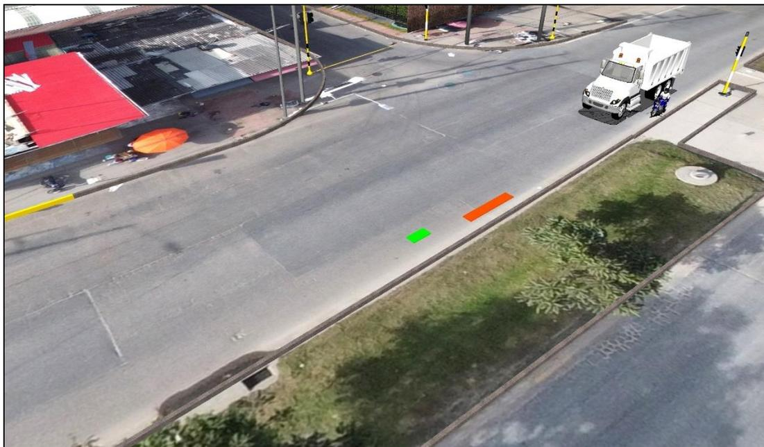
**Imagen No. 17:** En estas imágenes vistas en 3D se aprecia la secuencia de los vehículos antes de la pérdida de control de la motocicleta; nótese el área de color naranja donde se presentó la pérdida de control por parte del conductor de la motocicleta, y el área verde donde interactuaron los vehículos.
