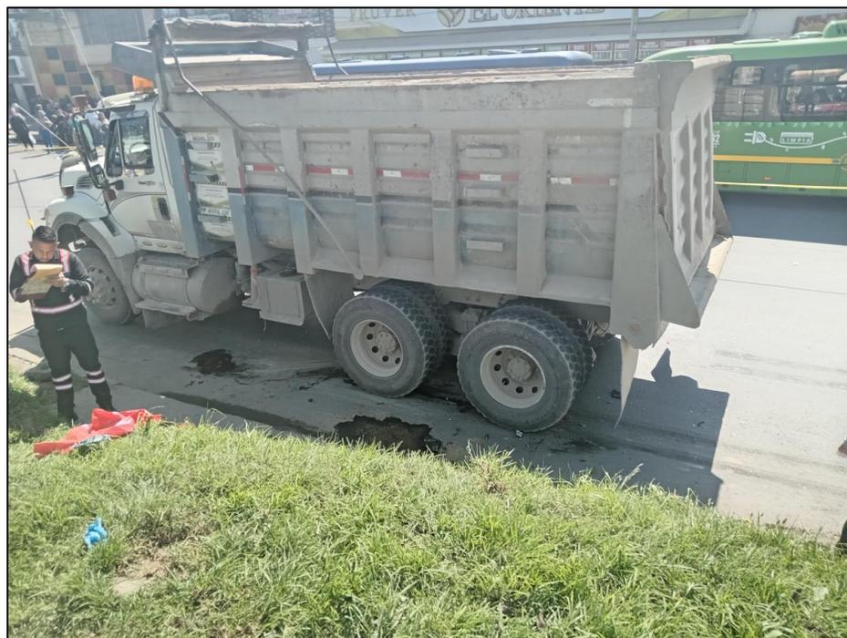
**Fotografías No. 18 y 19:** En estas fotografías se aprecian las huellas de frenado, huellas de arrastre metálico, y vestigios sobre la vía.
