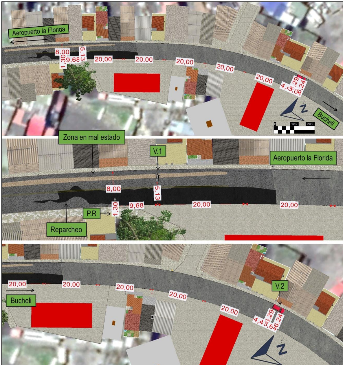
Imagen No. 18: Imagen compuesta de vista en planta de la elaboración a escala en el software Trimble Forensic Reveal, del Bosquejo elaborado para el evento; Se incluyen las condiciones y estado de la vía, así como también la línea central de carril amarilla para referenciar la separación de carriles de acuerdo con lo consignado en la casilla 7.9 del informe de la autoridad, (existente para el día de los hechos), sin embargo, con la información disponible no es posible establecer la demarcación sobre la vía para el día de los hechos.
