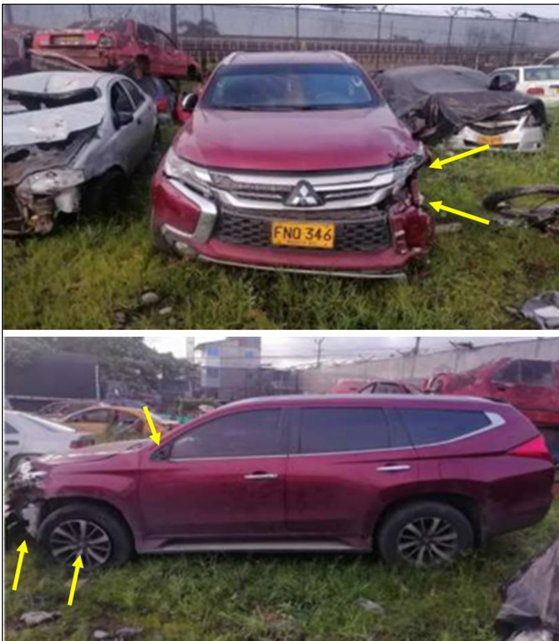
Imagen No. 16: En estas imágenes sustraída del formato de policía judicial -FPJ-16 se observa el estado final de la zona la frontal tercio izquierdo del vehículo No. 1, se evidencia que tiene afectación en el bómper anterior, persiana anterior, unidad de luz, capó, guardabarro, y rueda anterior.
