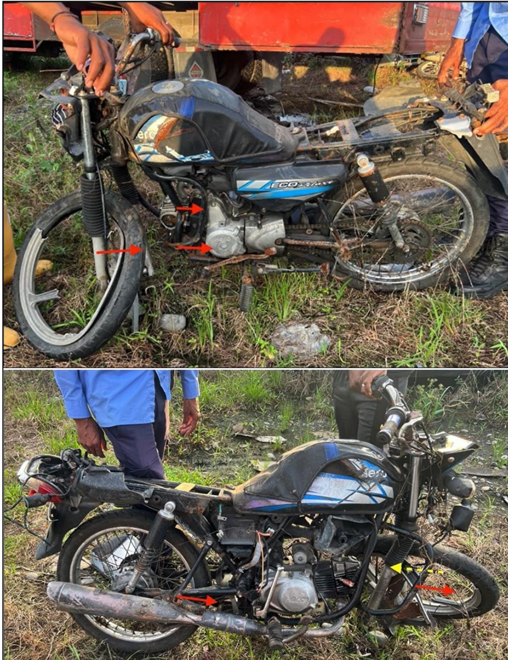
Imagen No. 10: compuesta por registros aportados para el análisis del caso, donde se observa el estado final del vehículo, evidenciando desplazamiento de las barras de suspensión y de la defensa parte izquierda hacia atrás, fractura aspas del rin de la rueda anterior, rotura del carenaje, unidad de luz, y con ausencia de espejos retrovisores.
