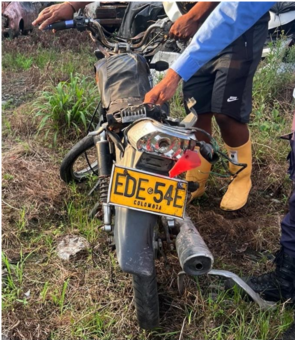
Imagen No. 11: aportada para el análisis del caso, donde se observa el estado final de la zona posterior del vehículo, identificando la deformación en la zona posterior.
