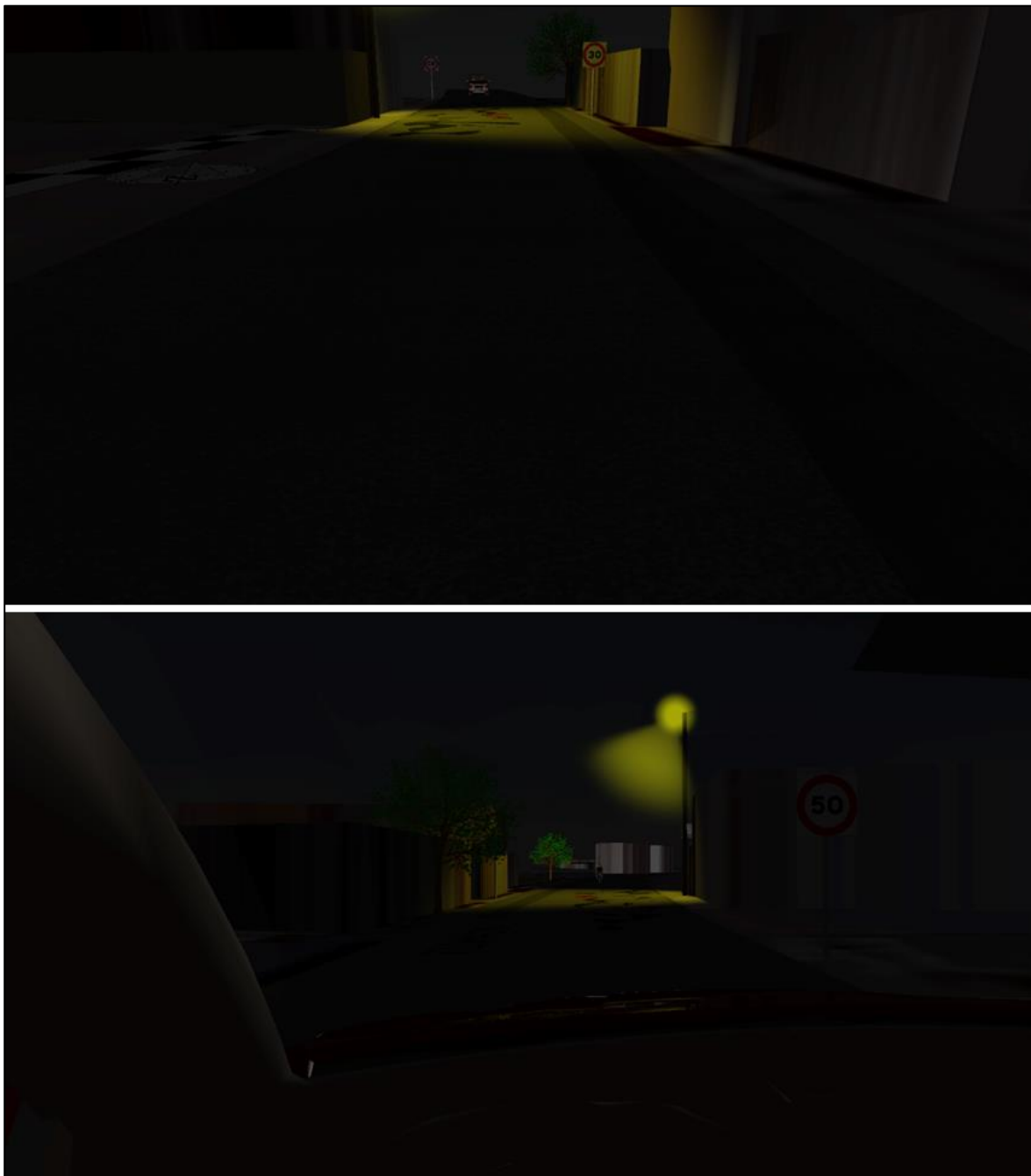
Imagen No. 32: representación de la posible visual de los conductores 2 segundos antes de la colisión para el caso ejemplo de ausencia de luces frontales funcionales o activadas.
