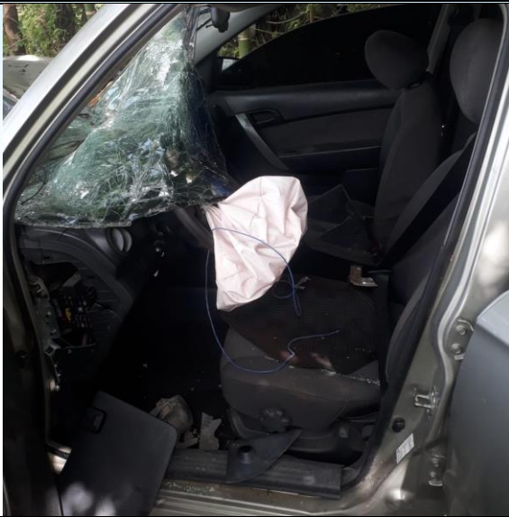
Fotografía número 17 en primer plano: En esta imagen se observa el interior del vehículo de placas KIM-195 , donde se aprecia la parte anterior, presenta activación de la bolsa de aire y rotura del vidrio panorámico: Conjunto en mal estado.
