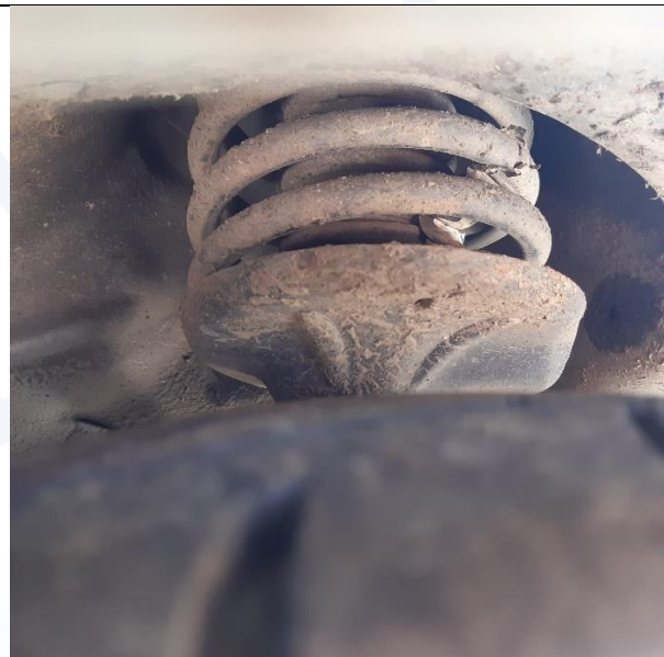
Imagen N° 13: En esta imagen se observa el sistema de suspensión tipo espiral
