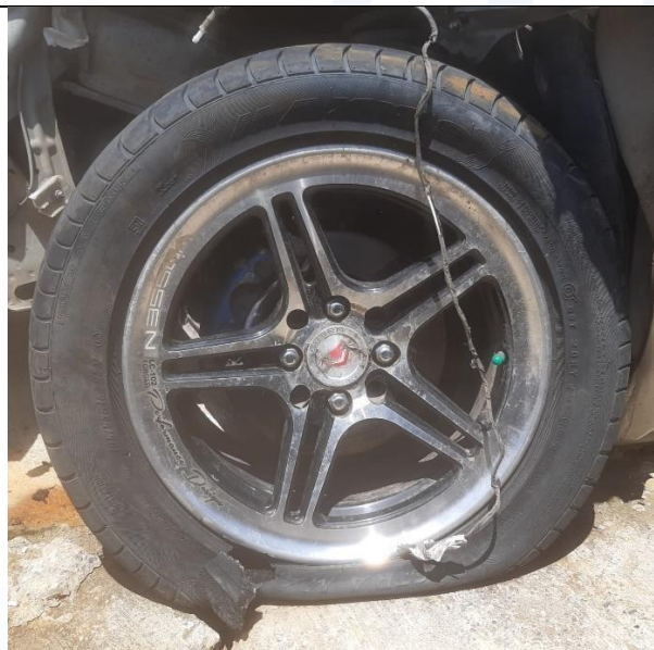
Imagen N° 29: En esta imagen se observa la llanta anterior izquierda del vehículo clase Automóvil se evidencia rotura de la llanta
