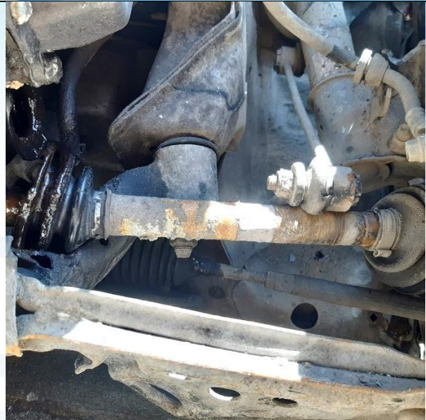
Imagen N° 11: En esta imagen se observa el brazo de la dirección del vehículo clase Automóvil se evidencia espaciamiento en su componente: Conjunto en mal estado.
