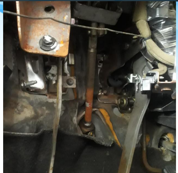
Fotografía número 22 en primer plano: En esta imagen se observa el poste de la dirección del vehículo de placas KIM-195 : Conjunto en buen estado estructural.
