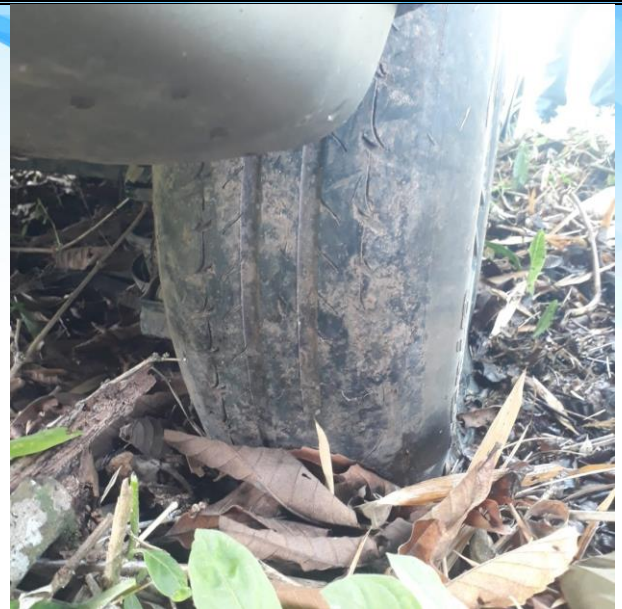
Fotografía número 37 en primer plano: En esta imagen se observa el labrado de la llanta posterior derecha del vehículo de placas KIM-195 : llanta tipo neumática, Según el profundímetro el labrado de la llanta es de 2.6 mm, regular estado.
