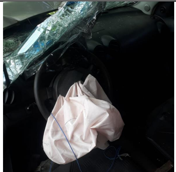
Fotografía número 20 en primer plano: En esta imagen se observa el volante del vehículo de placas KIM-195 , se aprecia activación de la bolsa de aire: Conjunto en mal estado.
