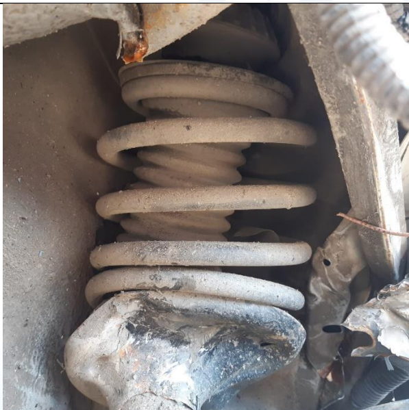
Imagen N° 12: En esta imagen se observa el sistema de suspensión tipo espiral
