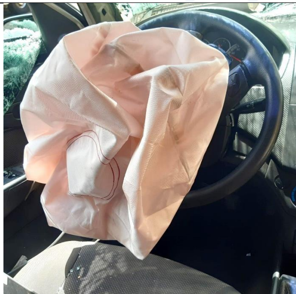
Imagen Nº 8: En esta imagen se observa el volante del vehículo clase Automóvil se evidencia activación de la bolsa de aire: Conjunto en mal estado.
