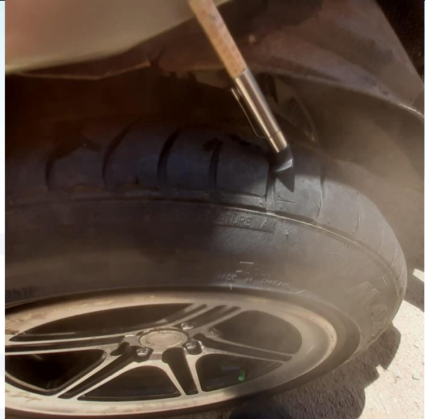
Imagen N° 24: En esta imagen se observa el labrado llanta anterior derecha del vehículo clase Automóvil: llanta tipo neumática o de lona, Según el profundímetro el labrado de la llanta es de 5mm en buen estado.
