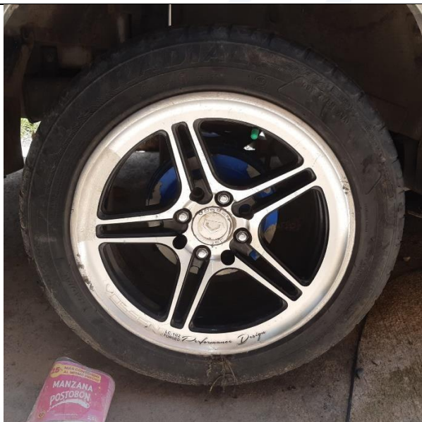
Imagen N° 25: En esta imagen se observa la llanta posterior derecha del vehículo clase Automóvil: Conjunto en buen estado.
