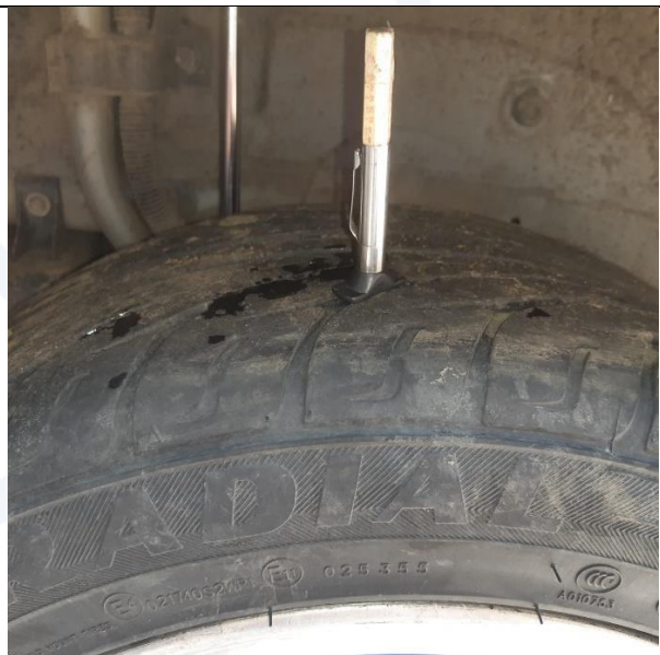
Imagen N° 26: En esta imagen se observa el labrado llanta posterior derecha del vehículo clase Automóvil llanta tipo neumática o de lona, Según el
