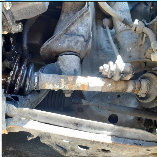
Imagen Nº 11: En esta imagen se observa el brazo de la dirección del vehículo clase Automóvil se evidencia espaciamiento en su componente: Conjunto en mal estado.
