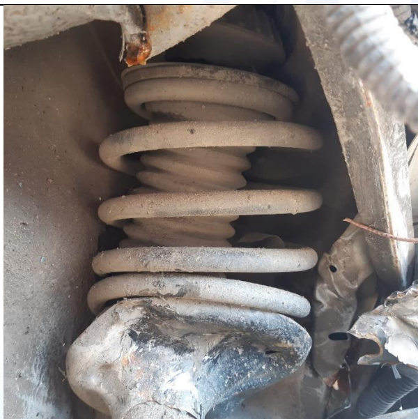
Imagen Nº 12: En esta imagen se observa el sistema de suspensión tipo espiral
