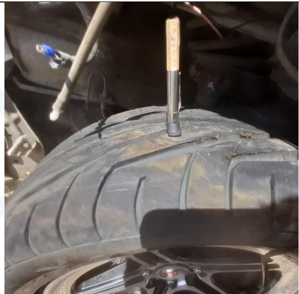
Imagen N° 30: En esta imagen se observa el labrado llanta anterior izquierda del vehículo clase Automóvil: llanta tipo
