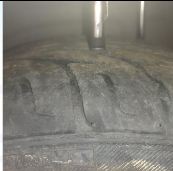
Imagen N° 28: En esta imagen se observa el labrado llanta posterior izquierda del vehículo clase Automóvil: llanta tipo neumática o de lona, Según el profundimetro el labrado de la llanta es de 5mm en buen estado.
