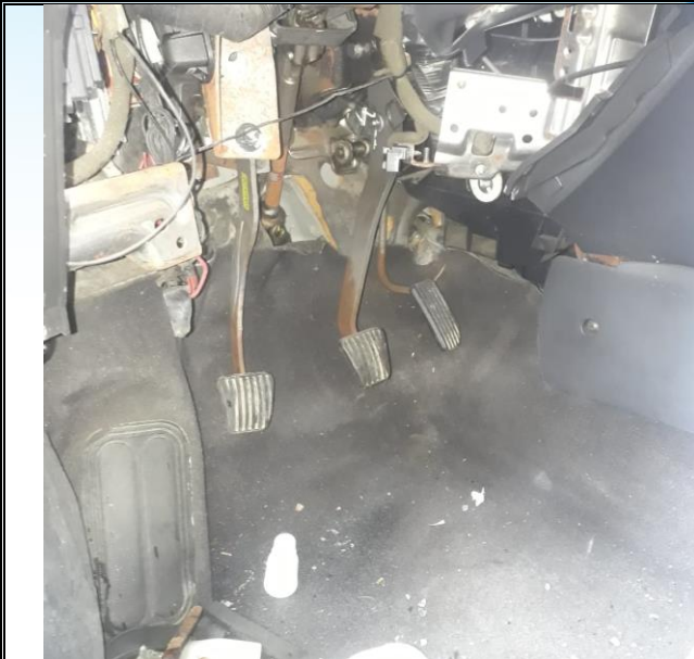
Fotografía número 21 en primer plano: En esta imagen se observan los pedales del vehículo de placas KIM-195 : Conjunto en buen estado estructural.
