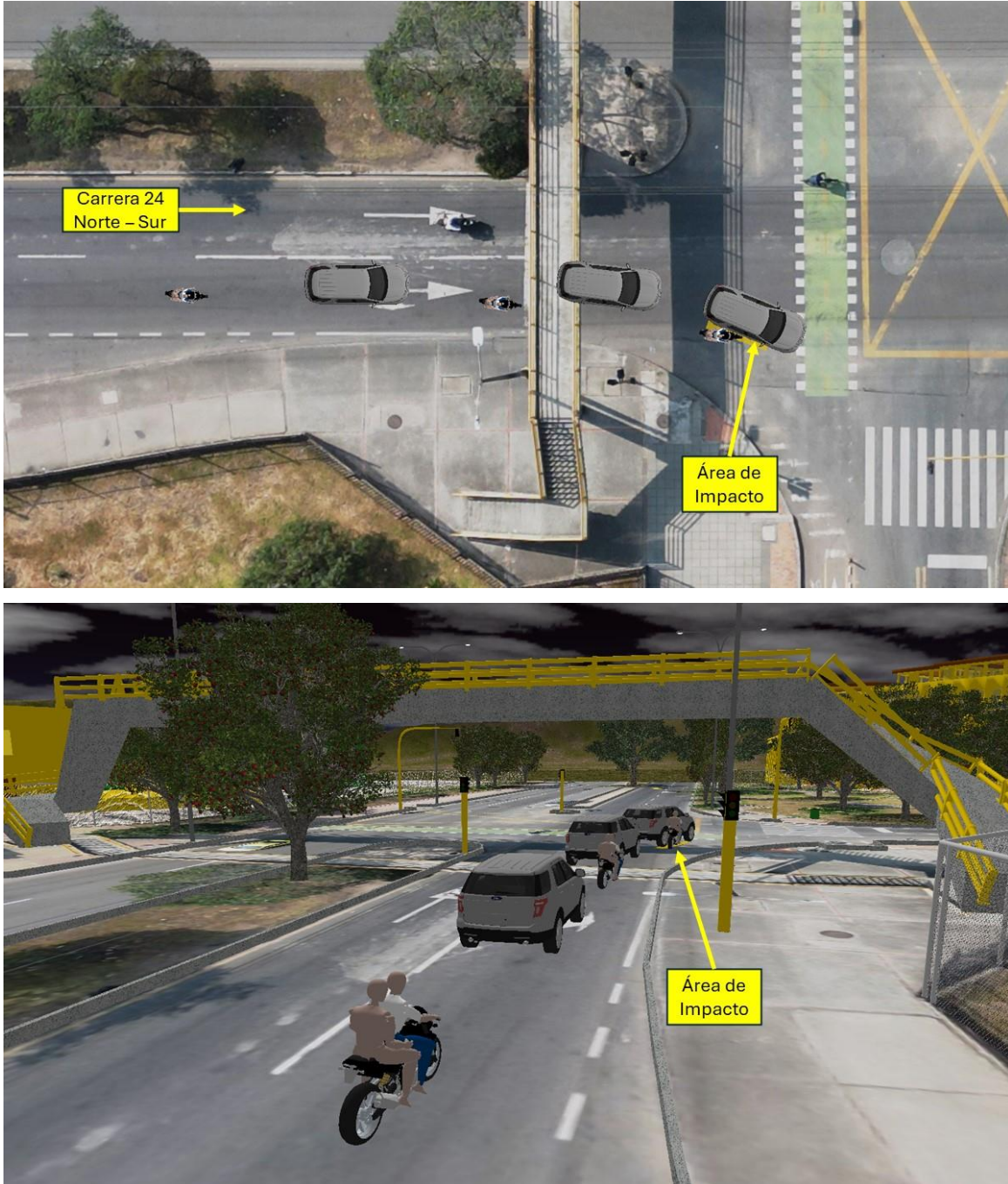
Imagen No. 18: En estas imágenes, vista en planta y 3D se aprecia la secuencia del accidente antes y al momento del impacto, nótese el sentido de desplazamiento de los vehículos y el área donde se presenta en la vía. Elaboración a escala en el software Trimble Forensics Reveal.
