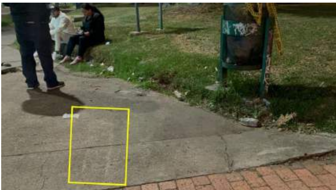
Fotografía No. 19 Plano Medio: En estas fotografías se aprecia una huella de arrastre metálico sobre la rampa de acceso al andén y la huella de arrastre sobre el andén.
