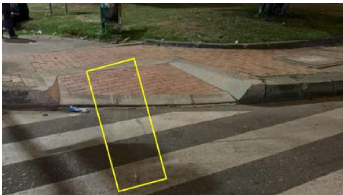
Fotografía No. 18 Plano General : En estas fotografías se observan huellas de arrastre metálico, las cuales se prolongan desde la calzada hasta el andén.
