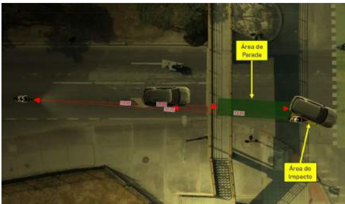
Imagen No. 55: En estas imágenes se aprecia que la motocicleta tendría un chance de evitar el accidente en un 100% si se desplaza a 30 km/h. Elaboración a escala en el software Trimble Forensics Reveal.
