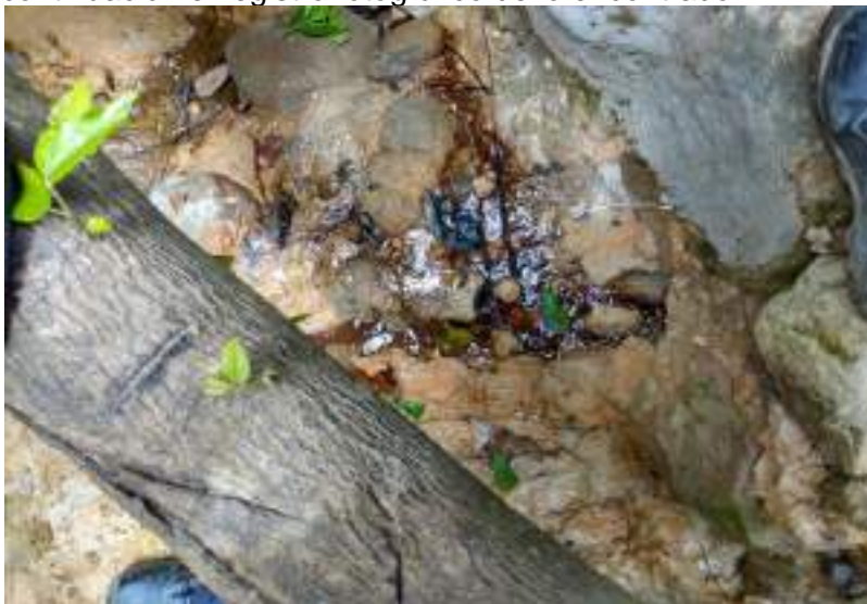
Evidencia de existencia de crudo en el suelo y base de la fuente de agua
