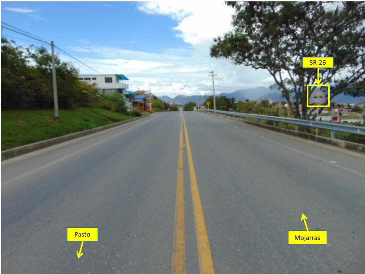
**FOTOGRAFÍA No. 3 PANORÁMICA:** En esta fotografía tomada por el equipo de IRS Vial en sentido Pasto – Mojarras a la altura del km 34 + 100 m, se aprecian las características generales de la vía, en la cual se encuentra demarcación horizontal de línea amarilla doble continua y líneas de borde, con señalización vertical SR-26 “prohibido adelantar”; en este sentido se desplazaba el vehículo No. 1 (Camioneta).
