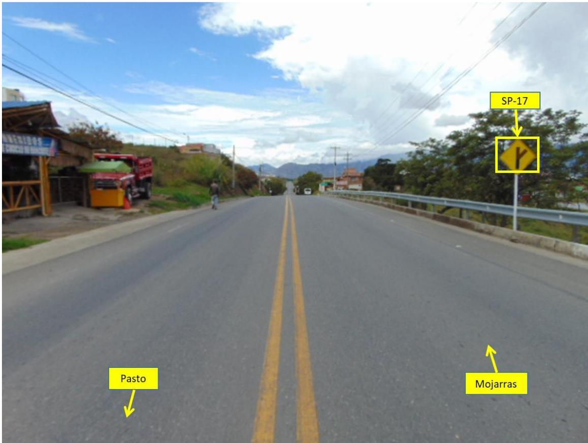
**FOTOGRAFÍA No. 4 PANORÁMICA:** En esta fotografía tomada por el equipo de IRS Vial en sentido Pasto – Mojarras a la altura del km 34 + 150 m, se aprecian las características generales de la vía, en la cual se encuentra demarcación horizontal de línea amarilla doble continua y líneas de borde, con señalización vertical SP-17 “Bifurcación derecha”; en este sentido se desplazaba el vehículo No. 1 (Camioneta).
