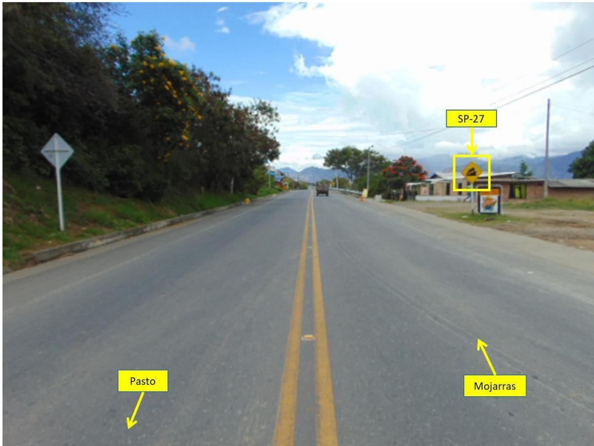
**FOTOGRAFÍA No. 2 PANORÁMICA:** En esta fotografía tomada por el equipo de IRS Vial en sentido Pasto – Mojarras a la altura del km 34 + 050 m, se aprecian las características generales de la vía, en la cual se encuentra demarcación horizontal de línea amarilla doble continua y líneas de borde, con señalización vertical SP-27 “Descenso peligroso”; en este sentido se desplazaba el vehículo No. 1 (Camioneta).
