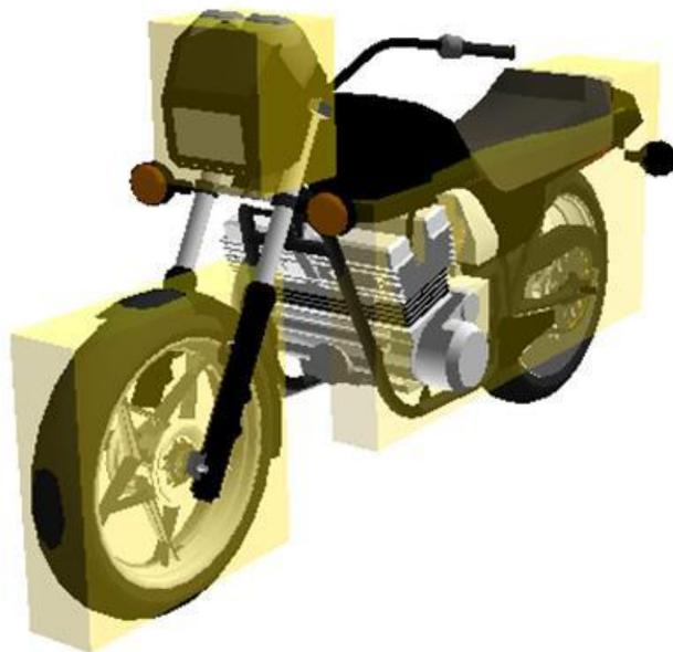
**IMAGEN No. 14:** En esta imagen se indica con los recuadros amarillos la ubicación de los daños o evidencia en la motocicleta.
