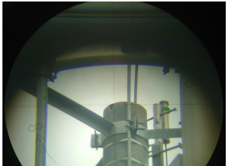
Proyección del eje en la parte superior del soporte para la antena tipo monopolo instalada dentro la planta El Guabito. Línea visual: ORIENTE-OCCIDENTE. Imagen tomada desde el teleobjetivo del equipo topográfico.
