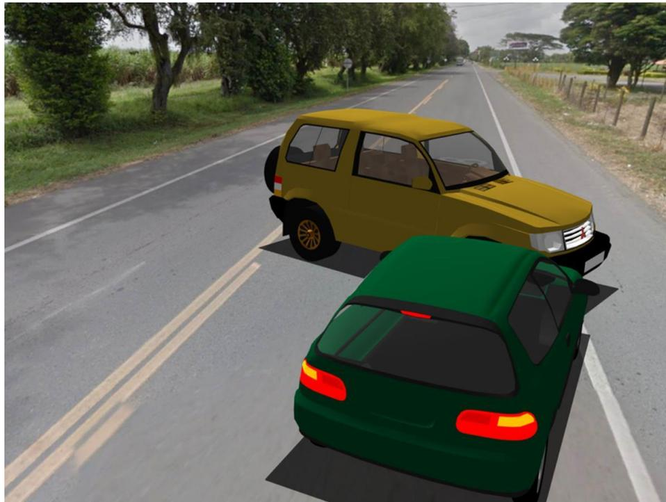
**IMAGEN No. 28:** En estas imágenes, vista en planta y en 3D se observa la posición relativa de los vehículos al momento del segundo impacto.
