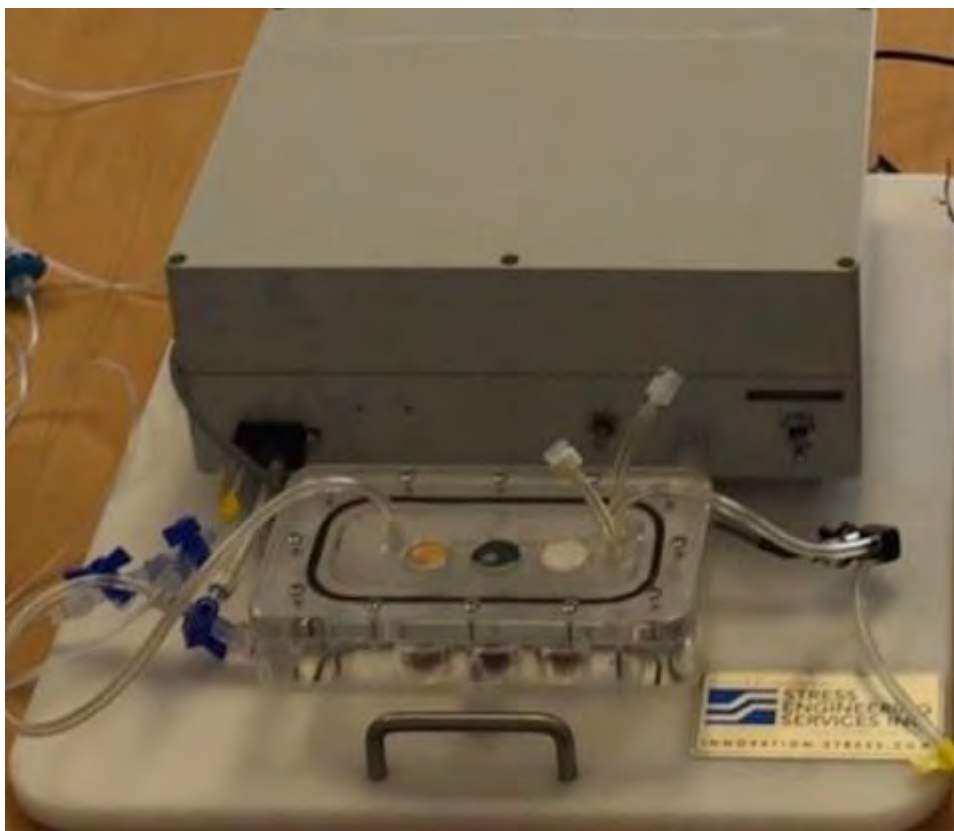
Figura 1: Dispositivo Perf-Alert. Contiene sensores para gas de hidrógeno ( H_2 ) y metano ( CH_4 ). Se conecta por medio de un tubo plástico estéril con cierre Luer a una llave de cierre d paso de un trócar estándar.
