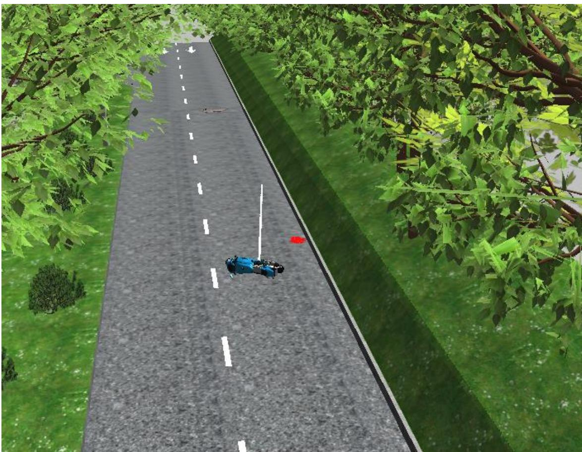
Imagen No 6. Vista de las posiciones finales de los EMP en 3 dimensiones elaborado en el software Faro Zone 3D
