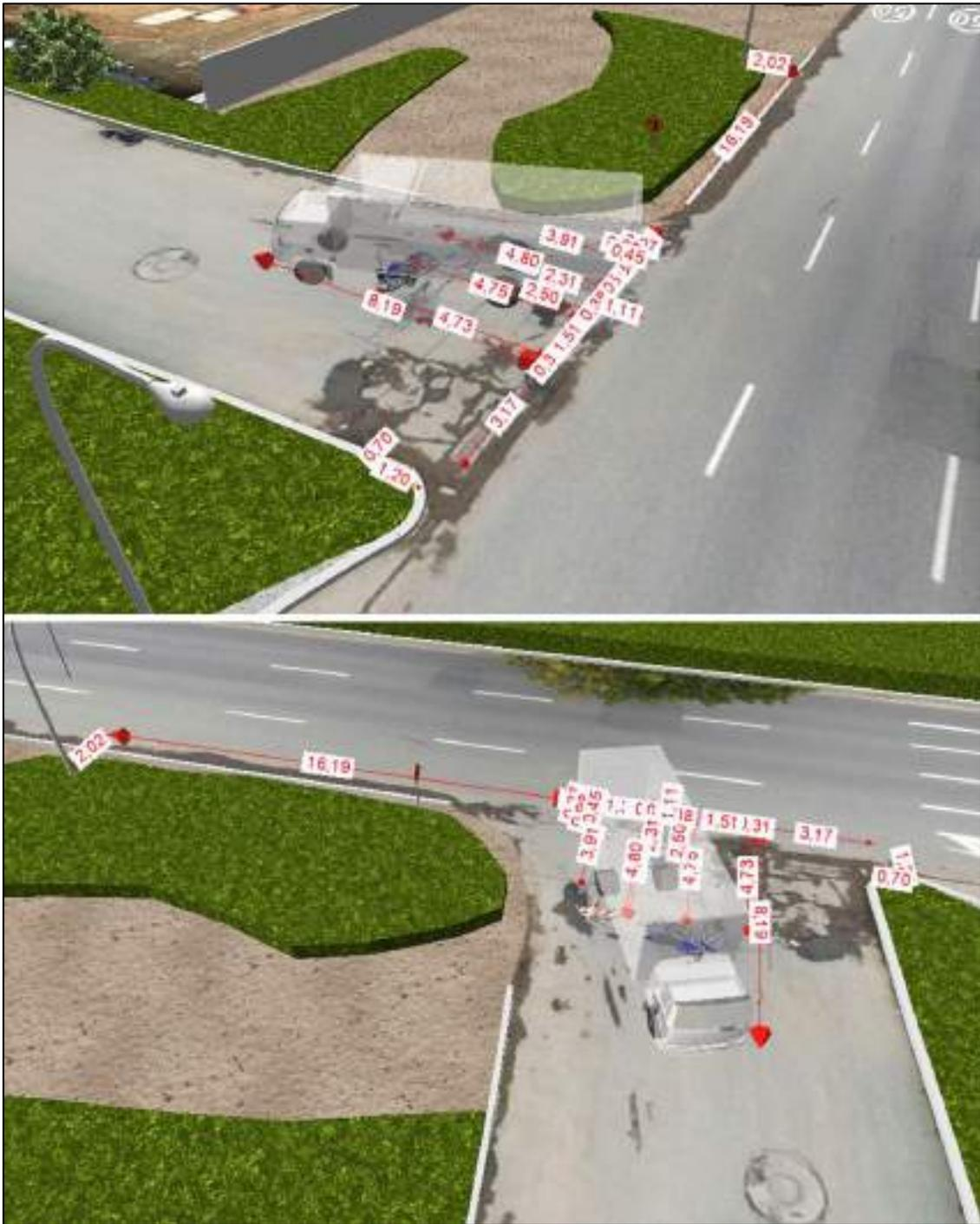
**Imagen No. 13:** En esta imagen vista en 3D se observa la elaboración a escala del bosquejo realizado para el evento en el software Trimble Forensics Reveal.
