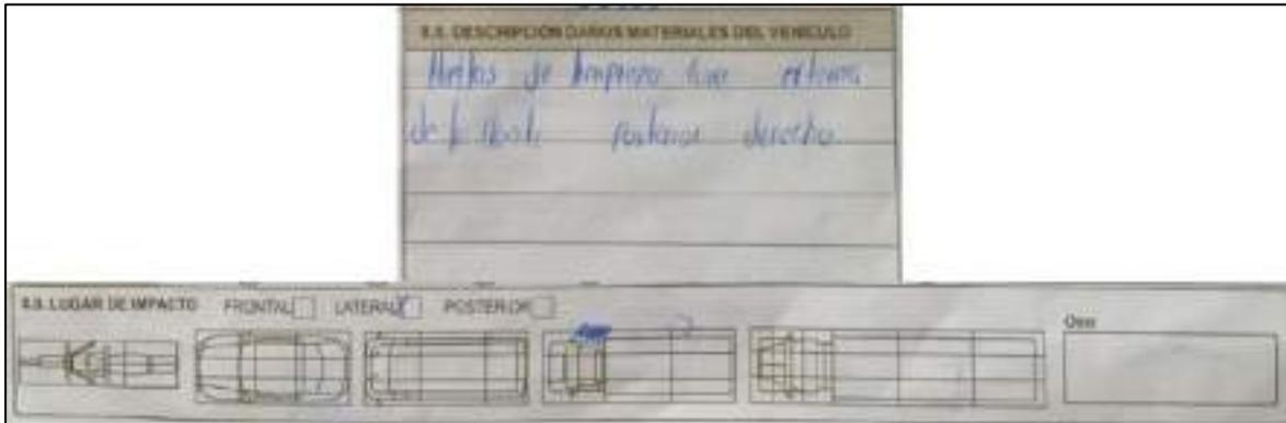
**Imagen No. 6:** En esta imagen se observa el diagrama del informe de la autoridad, donde hacen referencia a la zona de daños y descripción de estos. *“Huellas de limpieza cara externa de la llanta posterior derecha”*.
