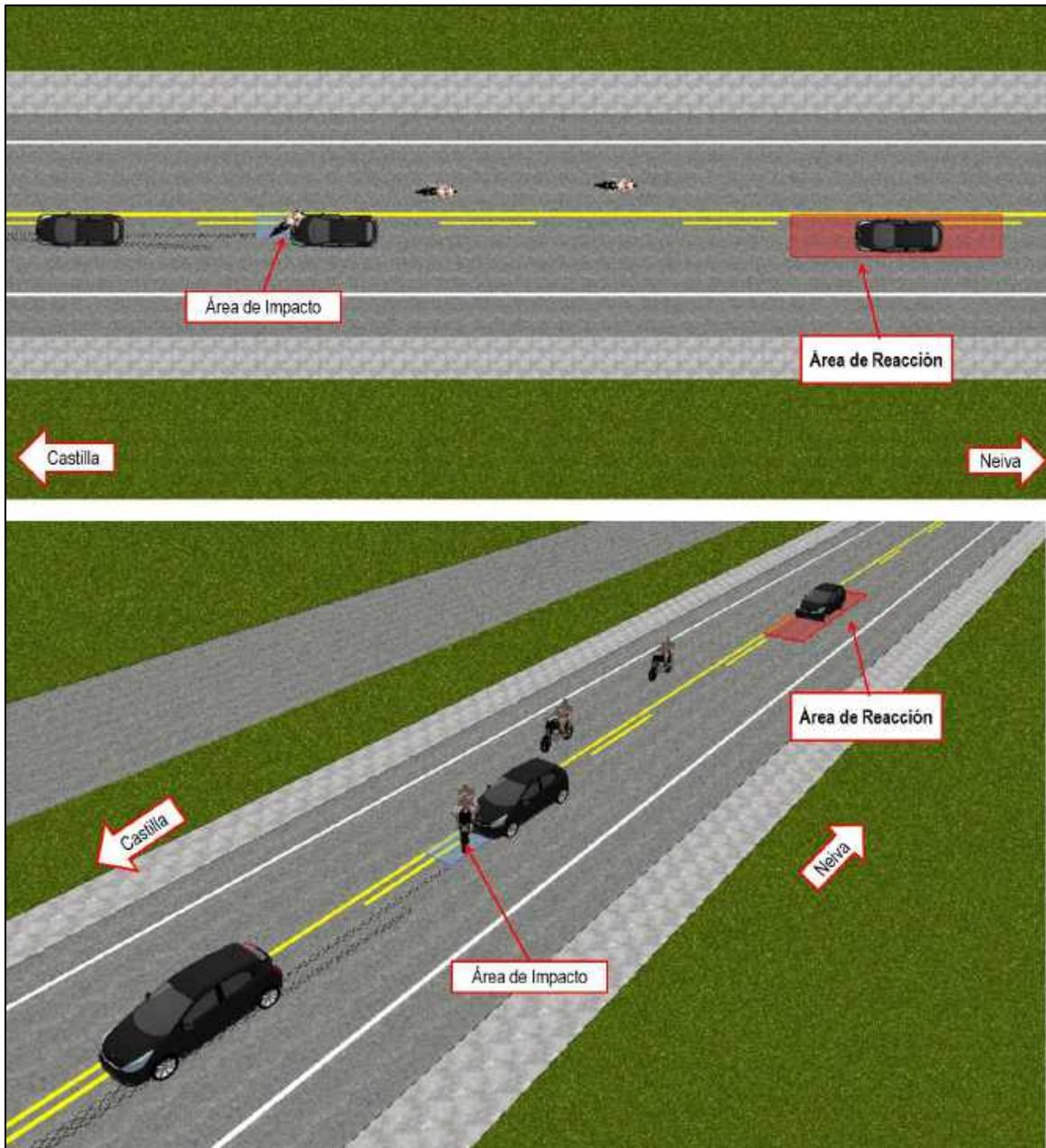
**Imagen No. 27:** En estas imágenes se observa la ubicación de los vehículos cuando el conductor del automóvil percibe el riesgo, entre 1,2 s y 1,5 s antes del inicio de las huellas de frenado; se observa el área roja de reacción, la cual encuentra 32 y 35 m atrás del impacto.
