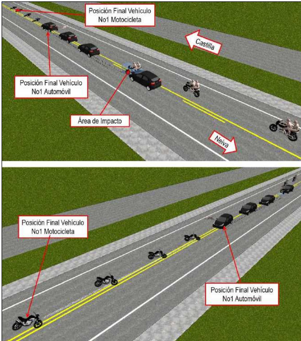
**Imagen No. 26:** En estas imágenes en 3D, se observa la secuencia del accidente, nótese el sentido de desplazamiento de los vehículos, el área de impacto de color azul y sus desplazamientos hasta sus posiciones finales.
