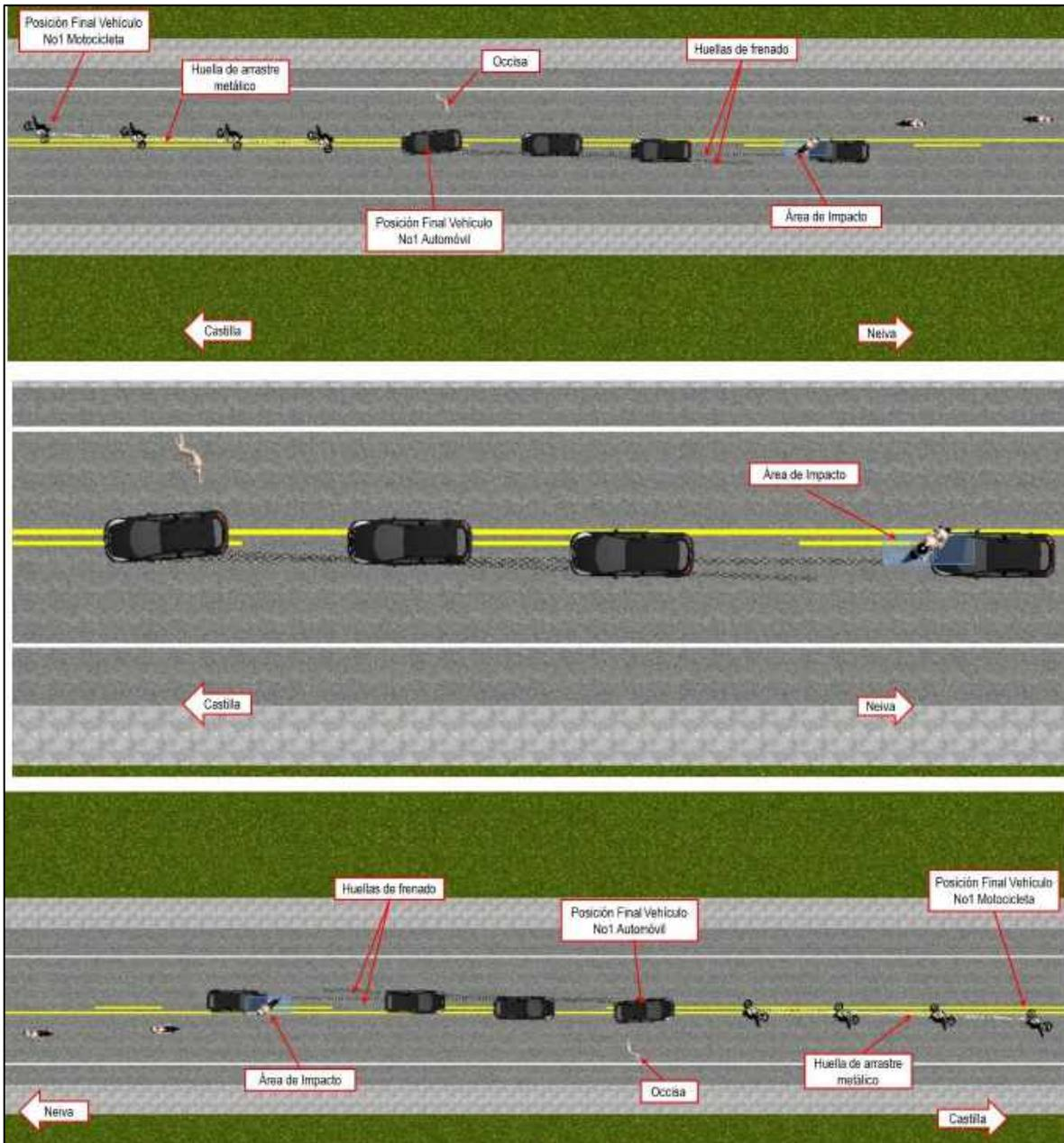
**Imagen No. 25:** En esta imagen, vista en planta se observa la secuencia del accidente, nótese el sentido de desplazamiento de los vehículos, el área de impacto de color azul y sus desplazamientos hasta sus posiciones finales.
