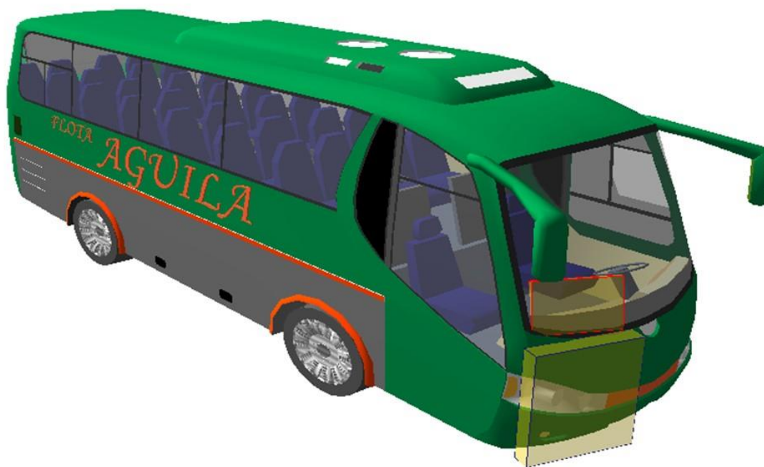
Imagen No.7: Basada en los reportes se resalta la zona de daños y evidencias en el rodante, se observa abolladuras entre la persiana y paragolpes anterior, costado derecho, se referencia una polifragmentación parcial del vidrio panorámico anterior.
