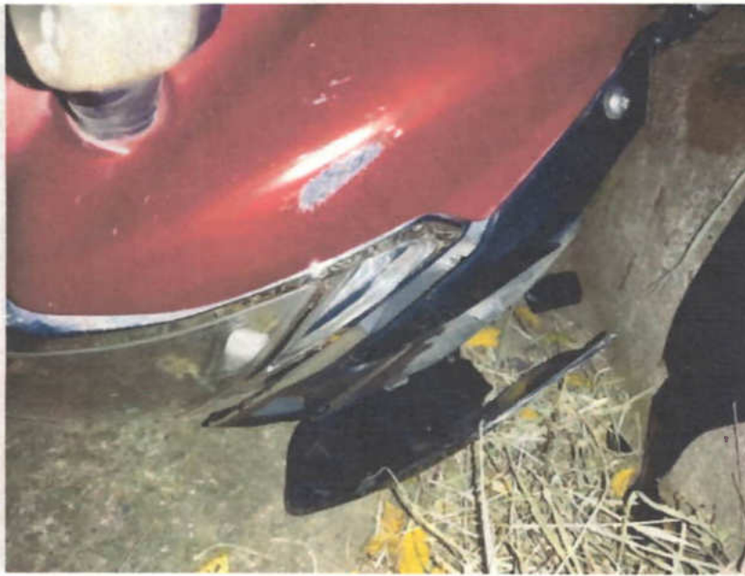
IMAGEN No.13. IMG_20211101_213944. PRIMER PLANO. EMP Y EF 1: FOTOGRAFÍA QUE PERMITE OBSERVAR LOS RAYONES Y ROTURA DEL SISTEMA DE CARENADO ANTERIOR DERECHO DE LA MOTOCICLETA DE PLACA TZF19D.
