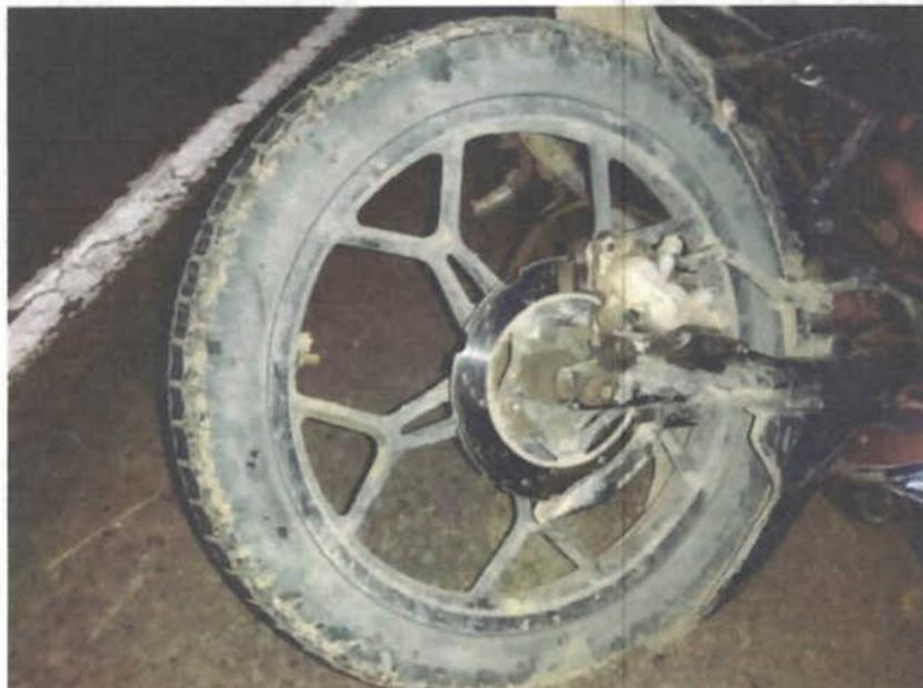
IMAGEN No.8. IMG\_20211101\_213649. PLANO MEDIO. EMP Y EF 1: FOTOGRAFÍA QUE PERMITE OBSERVAR LA LIMPIEZA O FRICCIÓN SOBRE EL SISTEMA DE LA RUEDA O LLANTA ANTERIOR LATERAL DERECHO Y LIMPIEZA SOBRE EL SISTEMA DE TUBO DE AMORTIGUACIÓN ANTERIOR LATERAL DERECHO DE LA MOTOCICLETA DE PLACA TZF19D.
