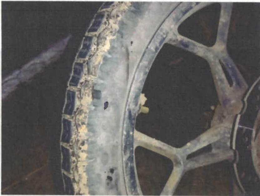
IMAGEN No.10. IMG\_20211101\_213732. PRIMER PLANO. EMP Y EF 1: FOTOGRAFÍA QUE PERMITE OBSERVAR LA LIMPIEZA O FRICCIÓN SOBRE EL SISTEMA DE LA RUEDA O LLANTA ANTERIOR LATERAL DERECHO DE LA MOTOCICLETA DE PLACA TZF19D.
