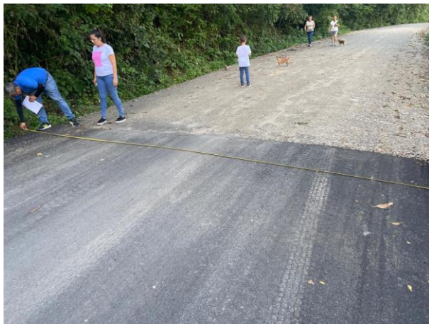
Figura 5. Ancho promedio de 5,80 m según diseño debe corresponder a 6 m.
