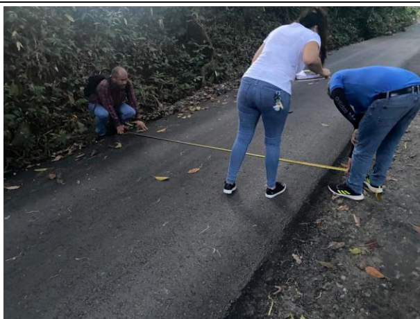
Figura 9. Ancho promedio de 2,80 m según diseño debe corresponder a 3 m, el carril derecho.
