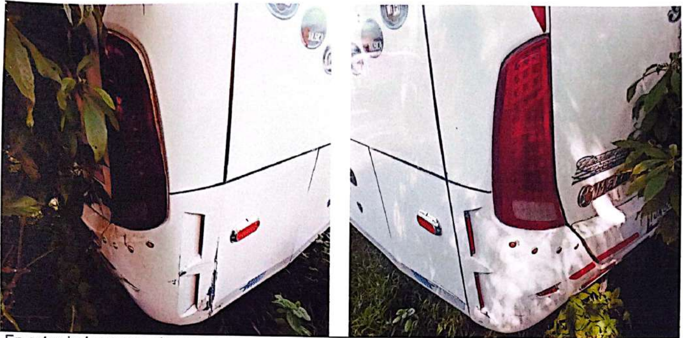
En estas imágenes se observa el sistema de alumbrado anterior y posterior, izquierdo y derecho del bus: Conjuntos en buen estado
