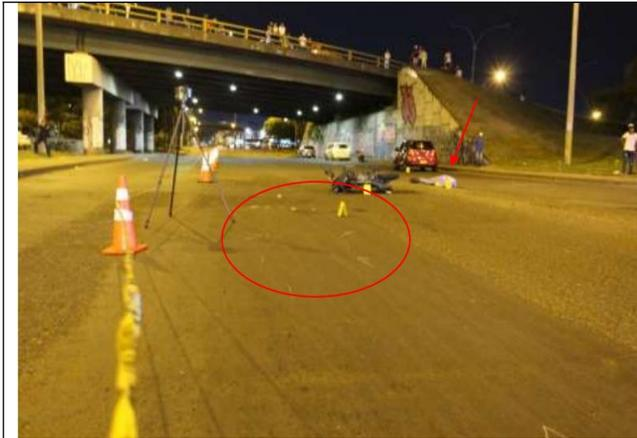
Imagen tomada del FPJ-11, corresponde en ovalo línea color rojo huella de arrastre metálico de motocicleta generada sobre la calzada, ( huella de arrastre de motocicleta al caer y marcar la superficie de rodadura con algún elemento metálico resistente)
