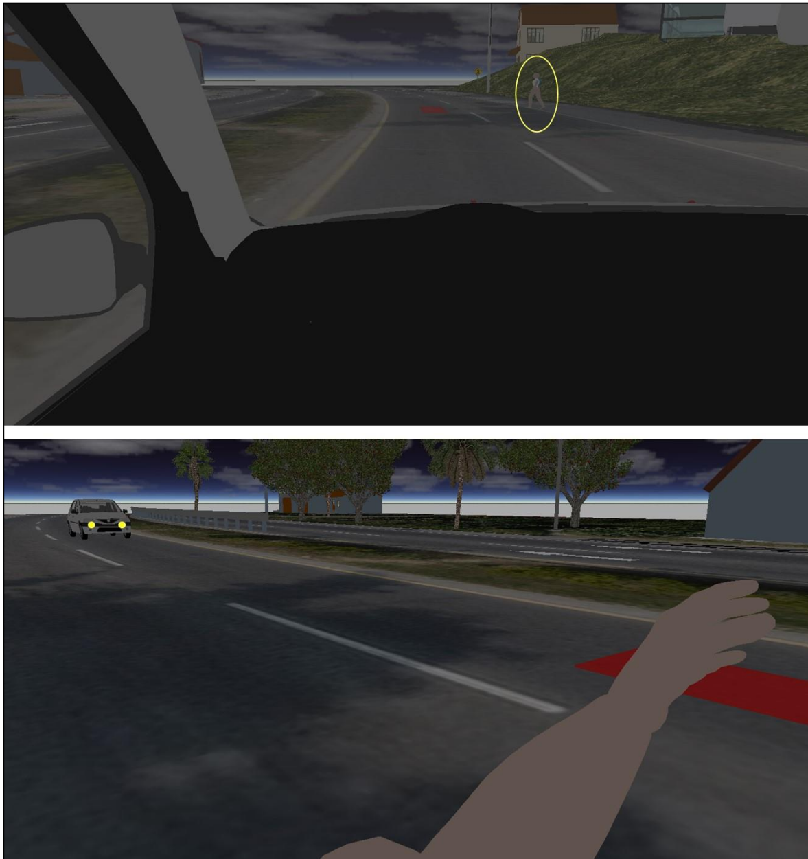
Imagen No. 20: En estas imágenes se observa la posible visibilidad que tenía el conductor del vehículo sobre los peatones y viceversa, al momento de éstos iniciar el cruce de la calzada, los separa 25 m aproximadamente.
