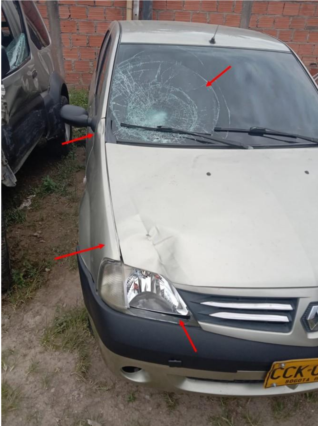
Fotografía No.8: En estas fotografías se aprecia el estado final del Automóvil, el cual presenta daños en su zona anterior vértice izquierdo, afectando piezas como: paragolpes anterior, unidades de luz, capó, panorámico anterior y espejo retrovisor derecho.
