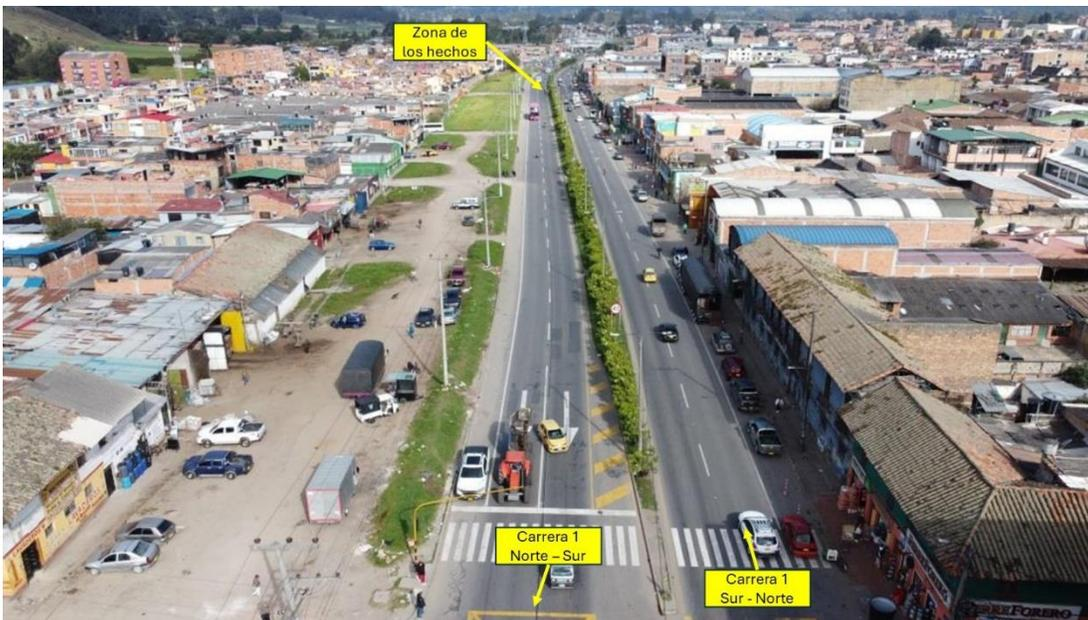
**Fotografía No. 3 Panorámica:** En estas fotografías tomadas por el equipo de IRS Vial en sentido norte – sur y viceversa en la carrera 1 frente al No. 8-16, se aprecian las características generales de la vía, en la cual se encuentra demarcación horizontal de línea blanca segmentada y líneas de borde, sin señalización vertical, al igual se observa el paso peatonal (cebra) y semáforo respecto al lugar de los hechos (320 m).
