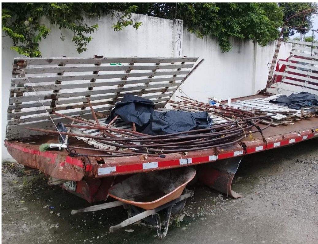
VISTA DE PLANCHON Y PARALES EN HIERRO Y CARROCERIA EN MADERA
