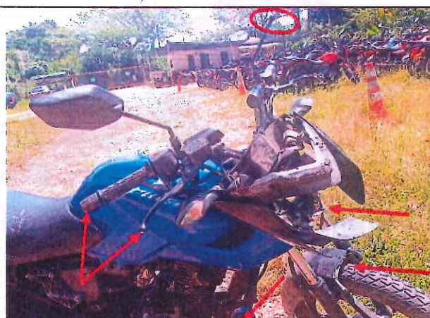
IMAGEN 06 PLANO MEDIO: detalle de los daños en la parte anterior derecha, debido a la colisión y volcamiento lateral derecho.
