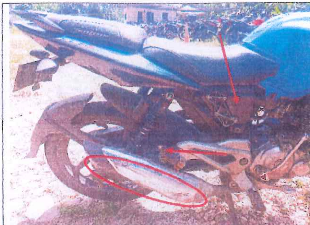
IMAGEN 07 PLANO MEDIO: ilustra los daños en la parte posterior derecha, producto del choque y volcamiento lateral derecho.
