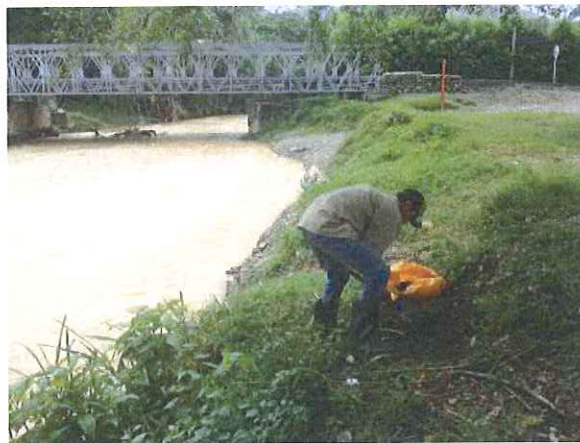
Toma de Muestras de material – Estudio de socavación
