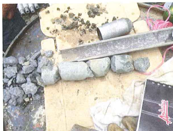
Trabajos de Perforación – Estribo Izquierdo
