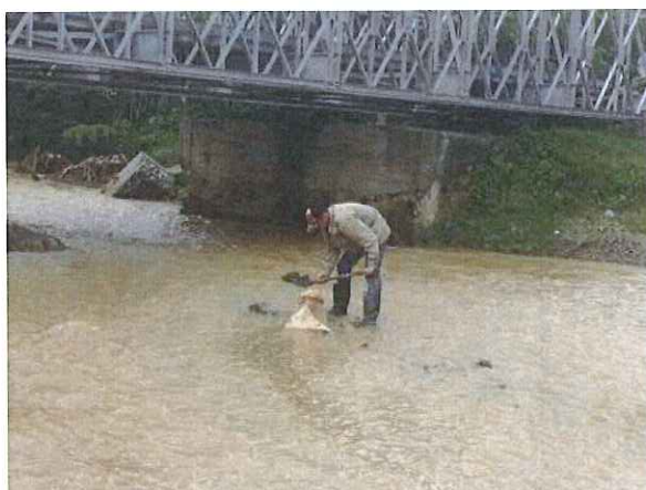
Toma de Muestras de material – Estudio de socavación
