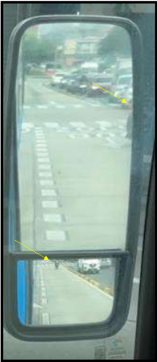
Ubicación de la motocicleta en el tercio izquierdo del carril y se puede apreciar el inicio de la pérdida del rango de visión en el espejo superior y el inicio del rango de visión en el espejo auxiliar inferior.
