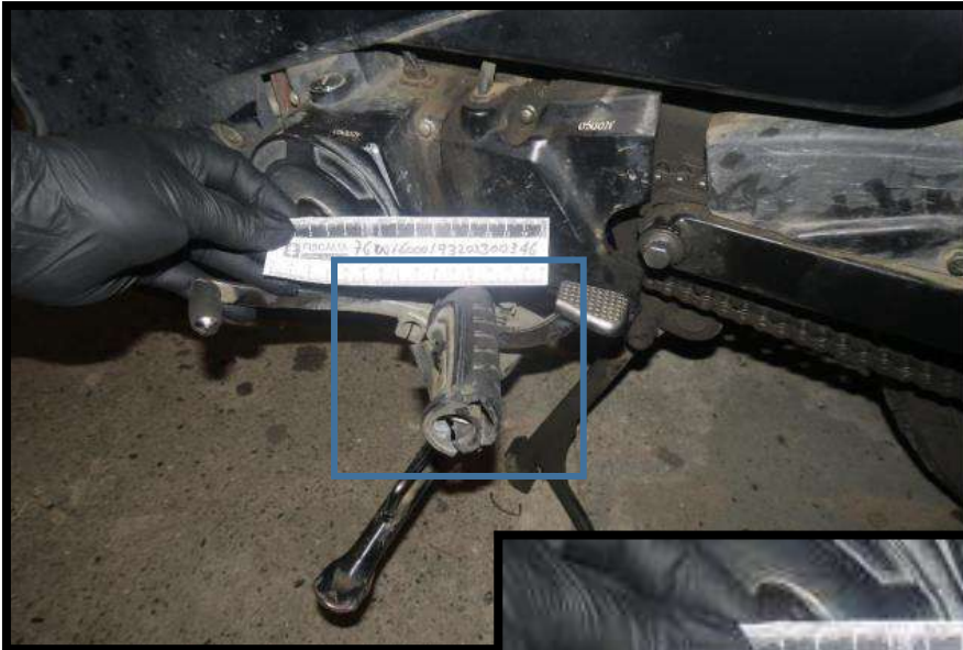
IMAGEN No. 30 Fijación fotográfica de la motocicleta, donde se puede evidenciar los daños en cala pie lado izquierdo.
