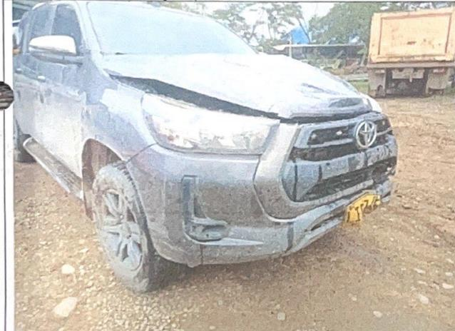
**IMAGEN No. 5:** Se observa en esta imagen parte anterior derecha del vehículo, se observa englobamiento del capo, placa doblada, abolladuras en la parte media de la defensa delantera, persiana y capo.
