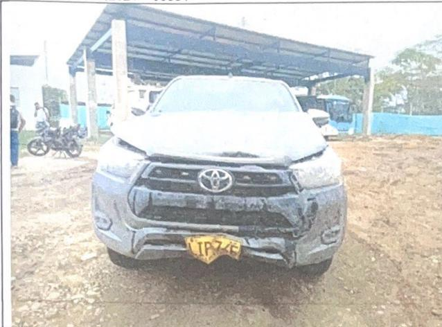
**IMAGEN No. 3:** Se observa en esta imagen parte anterior del vehículo, se observa englobamiento del capo, placa doblada, abolladuras en la parte media de la defensa delantera, persiana y capo.
