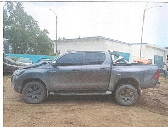
**IMAGEN No. 2:** Se observa en esta imagen costado izquierdo del vehículo, se observa englobamiento del capo.
