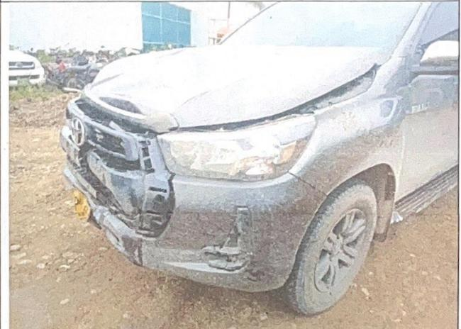
**IMAGEN No. 6:** Se observa en esta imagen parte anterior izquierda del vehículo, se observa englobamiento del capo, placa doblada, abolladuras en la parte media de la defensa delantera, persiana y capo.
