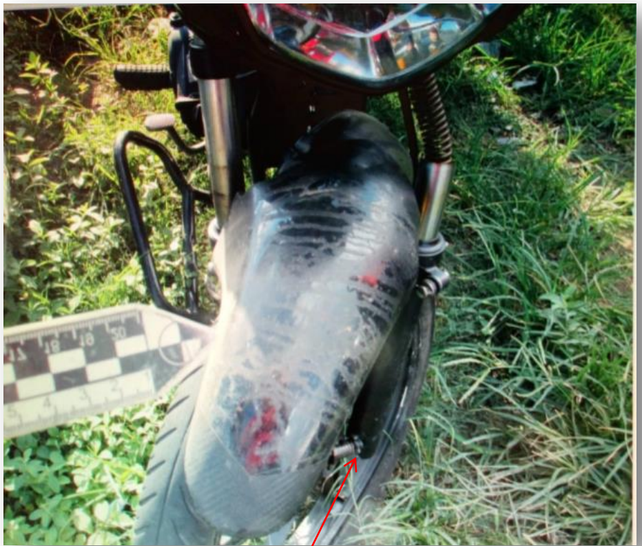
IMAGEN 5. MUESTRA UN IMPACTO POSITIVO POR RASPADO DE ADELANTE HACIA ATRÁS, EN EL EJE DELANTERO IZQUIERDO DE LA MOTOCICLETA.
