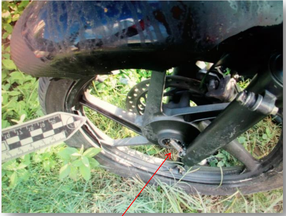
IMAGEN 4. MUESTRA EL PUNTO DE MÁXIMO ENGANCHE DE LA MOTOCICLETA CON EL AUTOMÓVIL. EL IMPACTO OCURRIÓ CON EL EJE COSTADO IZQUIERDO DONDE SE ALOJA LA BARRA TELESCÓPICA IZQUIERDA. LA PUNTA DEL EJE IZQUIERDO SE ENGANCHÓ CONTRA LA RUEDA DELANTERA IZQUIERDA DEL AUTOMÓVIL.
