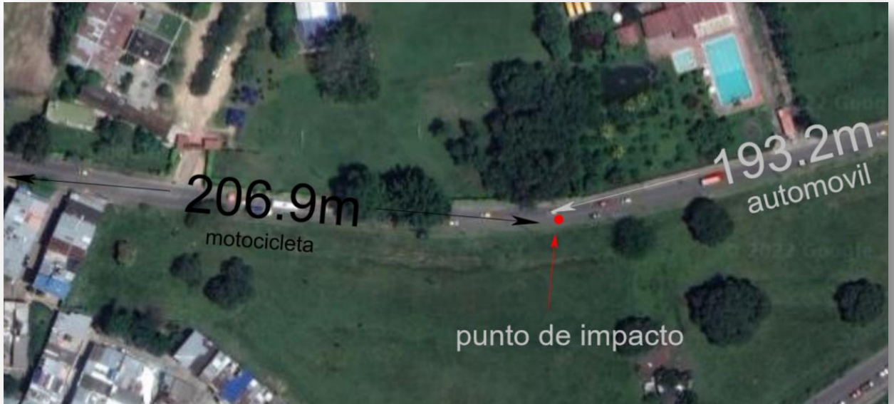
IMAGEN 9. SATELITAL POR GOOGLE MAPS. MUESTRA LA APLICACIÓN DEL SOFTWARE FARO ZONE 2D. EN LA MEDICIÓN DE LA DISTANCIA DE PERCEPCIÓN DISPONIBLE. EL CONDUCTOR DEL AUTOMÓVIL TENÍA UNA DISTANCIA DE PERCEPCIÓN DE 167.8MTS CON RESPECTO A LA MOTOCICLETA.
