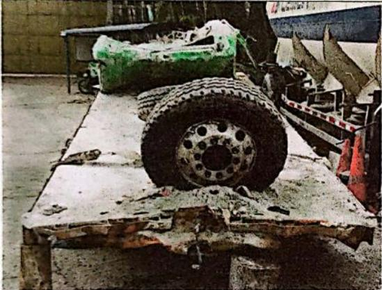
**IMAGEN\_03** que muestra la parte anterior del semirremolque con roturas y abolladuras nivel fuerte, además abrasiones y alojamiento de material terroso, encima se observa el eje y las llantas delanteras de la unidad tractora.
