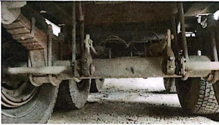
**IMAGEN\_07** que muestra la parte inferior posterior del semirremolque donde se observa parte del sistema de frenos, transmisión y suspensión en buen estado
