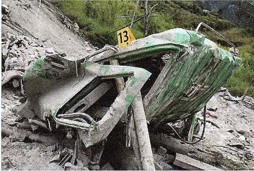
**IMAGEN N° 18 FOTOGRAFIA PRIMER PLANO:** EN ESTA IMAGEN SE PUEDE OBSERVAR LA POSICION FINAL DE LA CABINA DEL TRACTOCAMION MARCA INTERNATIONAL, LINEA 7600SBA, DE PLACAS SNR-177, MODELO 2012, COLOR VERDE, SERVICIO PUBLICO, TIPO DE CARROCERIA SRS, CAPACIDAD KG 19.489, MOTOR NRO 35292559, CHASIS NRO 3HSWYAHT0CN639716, LICENCIA DE TRANSITO NRO 10012040519; LA CUAL SUFRIO DESPRENDIMIENTO DEL CHASIS, ASI COMO MULTIPLES DAÑOS ESTRUCTURALES.
