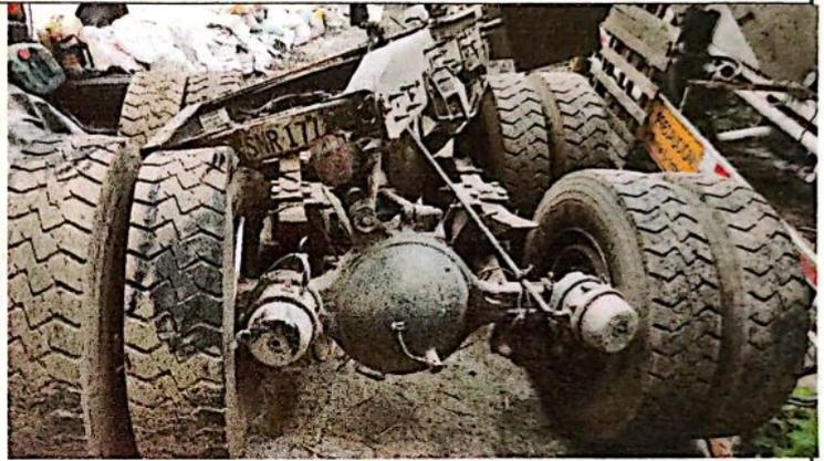
**IMAGEN\_04** que muestra la parte posterior de la unidad tractora, donde se aprecia parte del sistema de suspensión, frenos y ejes desacoplados del chasis
