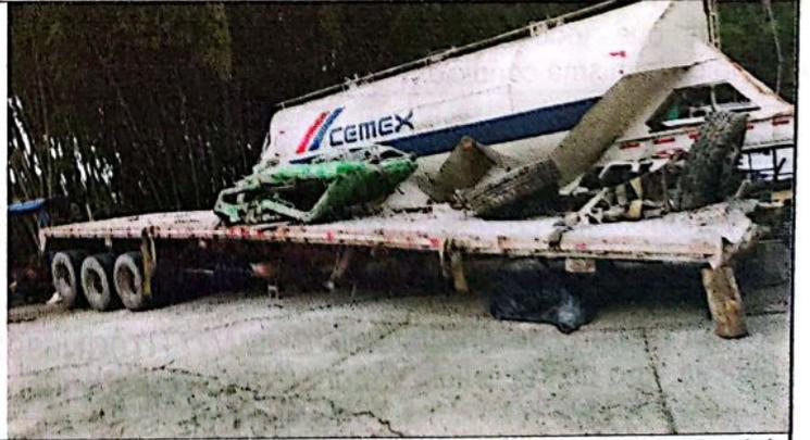
**IMAGEN\_06** que muestra la parte anterior izquierda del semirremolque con roturas y abolladuras nivel fuerte, además abrasiones y alojamiento de material terroso, encima se observa el eje y las llantas delanteras de la unidad tractora y la cabina con aplastamiento, roturas y abolladuras.
