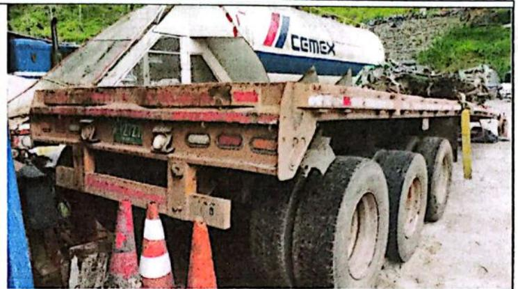
**IMAGEN\_08** que muestra parte posterior izquierda del semirremolque con abrasiones y alojamiento de material terroso.
