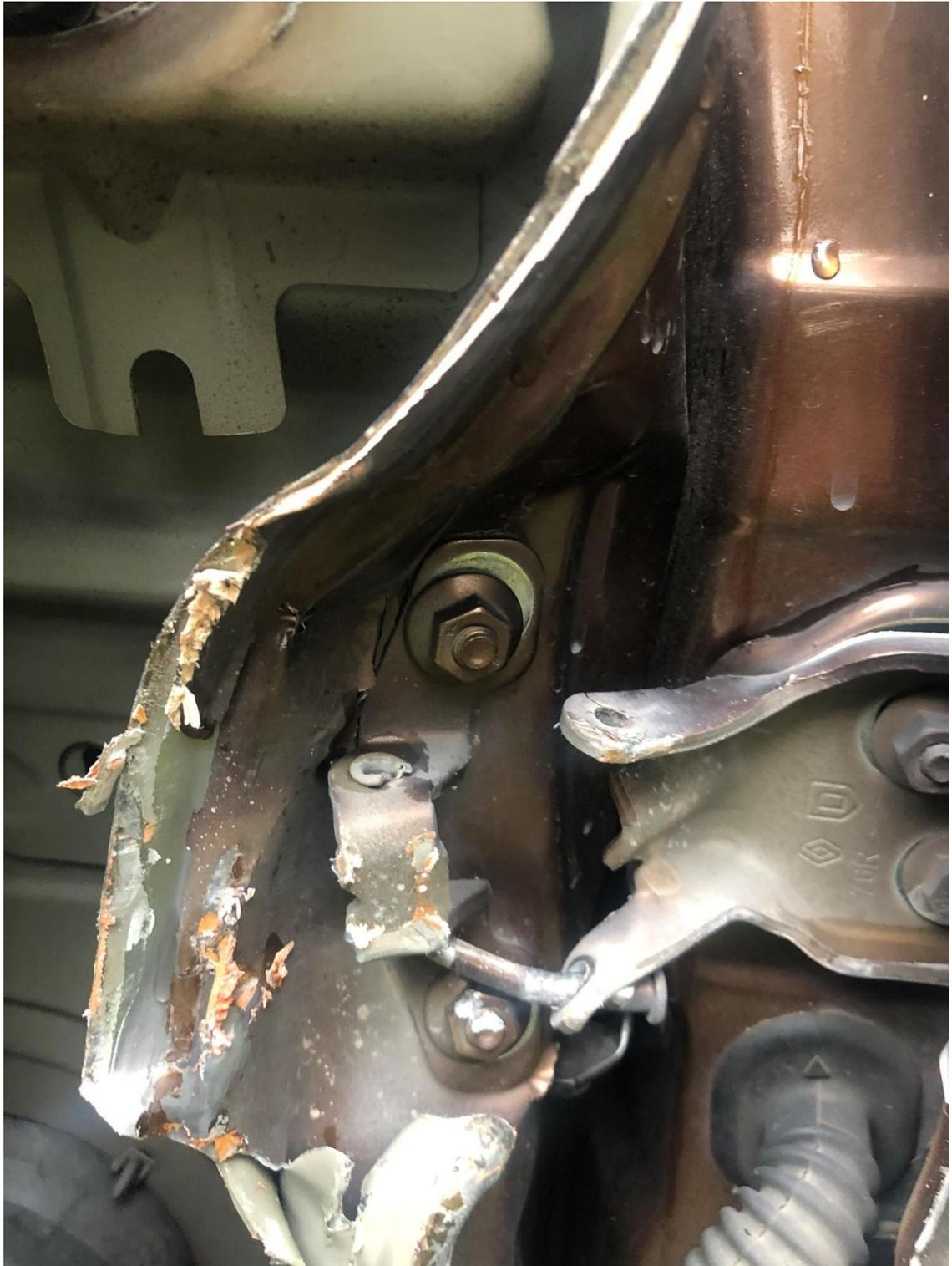
**Fotografía vista lateral derecha del vehículo MKN804, en la cual se prueba el desprendimiento del anclaje y parales de la puerta del copiloto del carro MKN804.**
