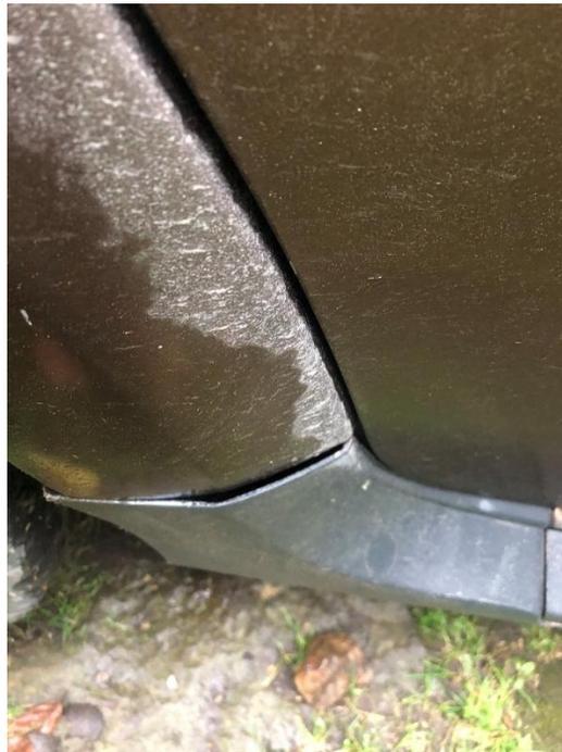
**Desplazamiento del guardabarros inferior derecho del vehículo MKN 804**
