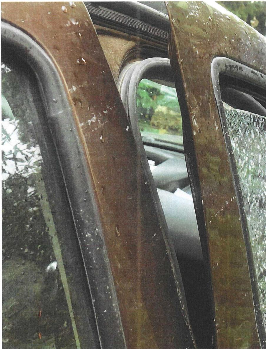
Fotografía vista lateral derecha parte baja del vehículo MKN804, en la cual se prueba que se desplazó la puerta del copiloto sobreponiéndose a la puerta trasera del carro MKN804, además se observa la ruptura total del vidrio de la puerta.
