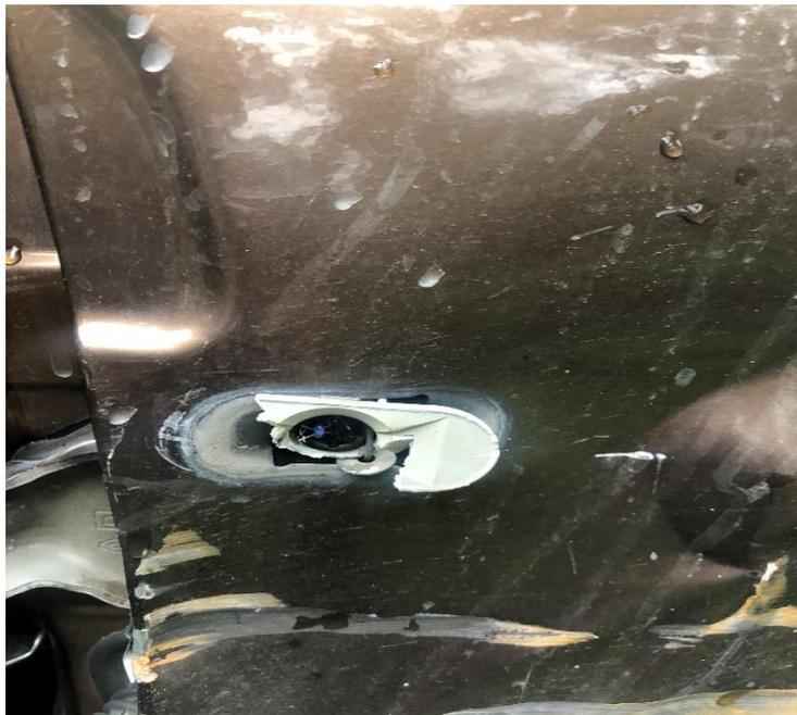
**Ruptura del cocuyo o direccional derecha del carro MKN804**
