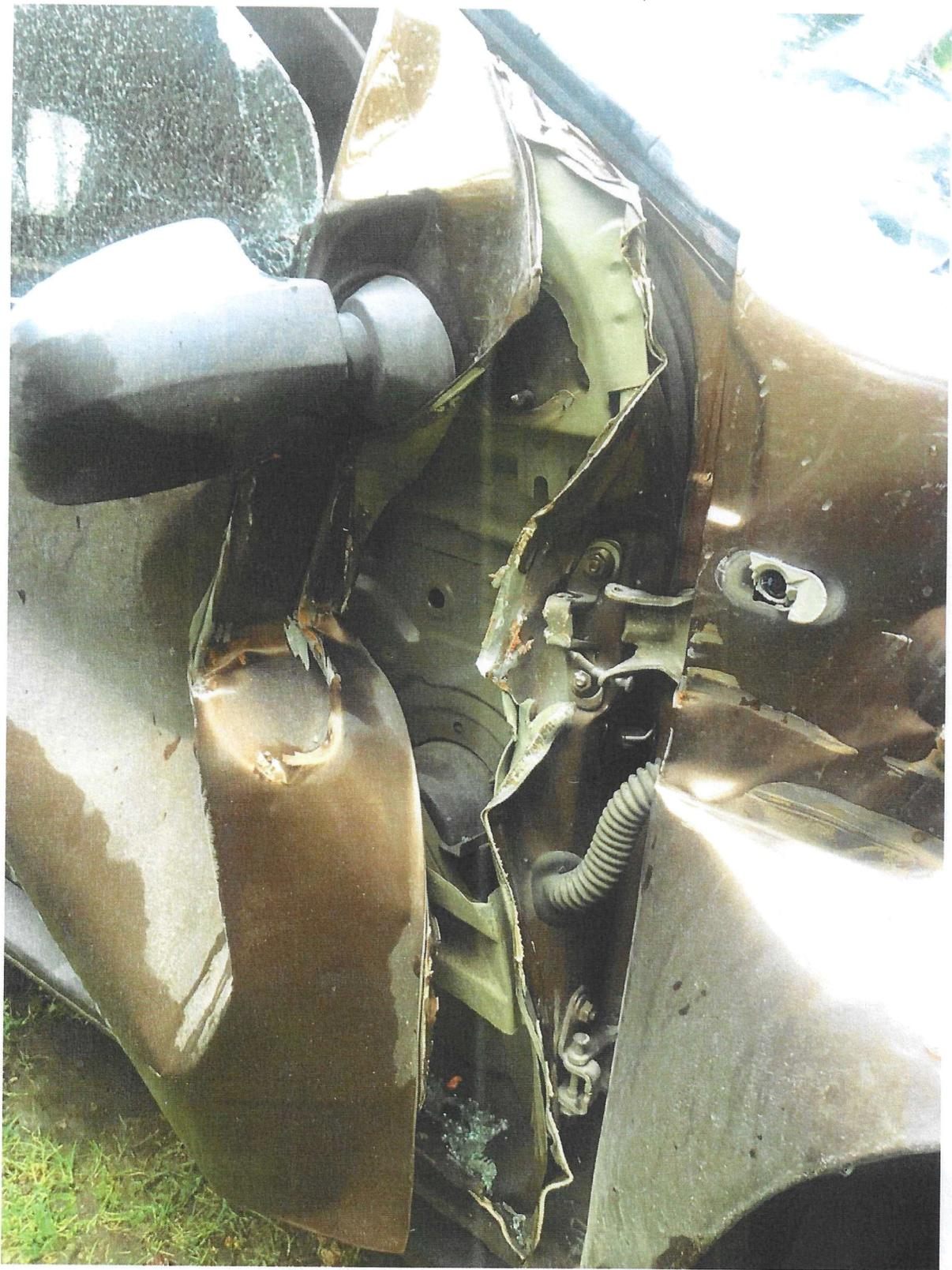
Fotografía lateral derecha del vehículo MKN804, se evidencia con mayor detalle el daño sufrido por la puerta del copiloto, guarda barro, espejo y vidrio derecho del carro MKN804.
