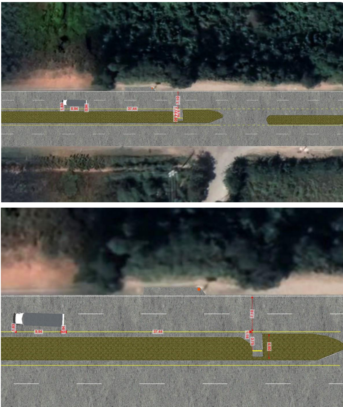
Imagen No. 9: En estas imágenes, vista en planta se observan las evidencias diagramadas en el croquis de la autoridad. Elaboración a escala en el software Trimble Forensics Reveal.
