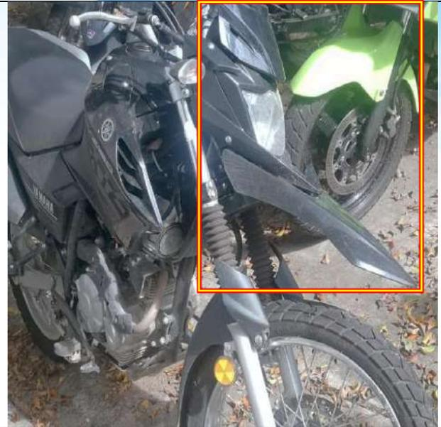
**Fotografías número 7 y 8 plano medio y primer plano:** En estas imágenes se observa y se resalta el costado lateral derecho del vehículo clase MOTOCICLETA de placa JSK-92G, se evidencian daños en el segmento del guardabarros anterior, en el segmento de la barra del sistema de suspensión anterior costado izquierdo, en el segmento del carenaje y en el segmento de la placa : Conjunto en mal estado.
