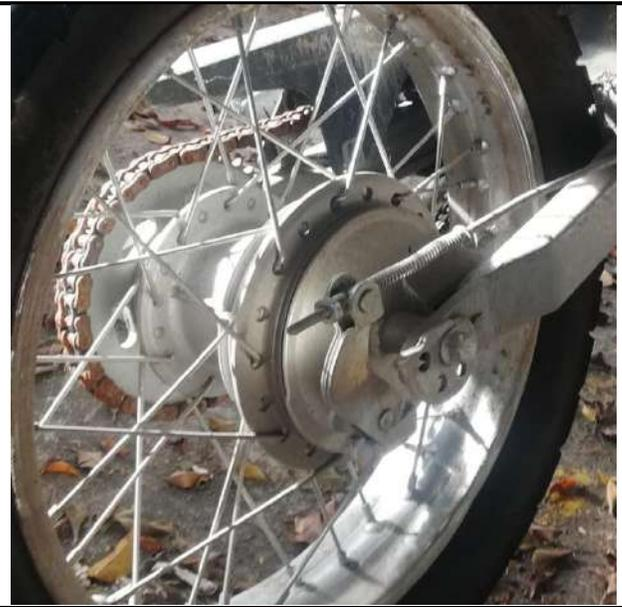
**Fotografía número 21 en primer plano:** En esta imagen se observa el sistema de frenos posterior tambor, del vehículo clase MOTOCICLETA de placa JSK-92G: Conjunto en buen estado.
