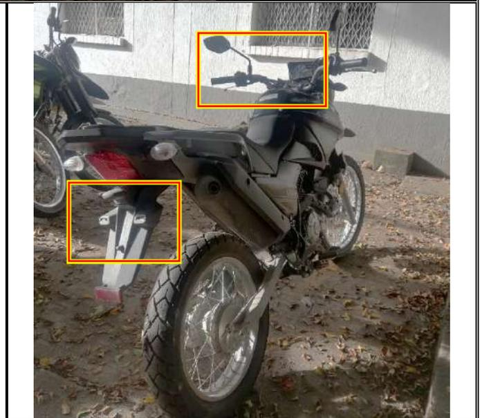
**Fotografías número 4, 5 y 6 plano medio y plano general:** En estas imágenes se observa y se resalta la parte posterior del vehículo clase MOTOCICLETA de placa JSK-92G, se evidencian daños en el segmento de la barra del sistema de suspensión anterior del costado izquierdo, en el conjunto del espejo izquierdo, en el segmento del carenaje, en el segmento de las tapas laterales del depósito de combustible costado izquierdo, en el segmento de algunas
