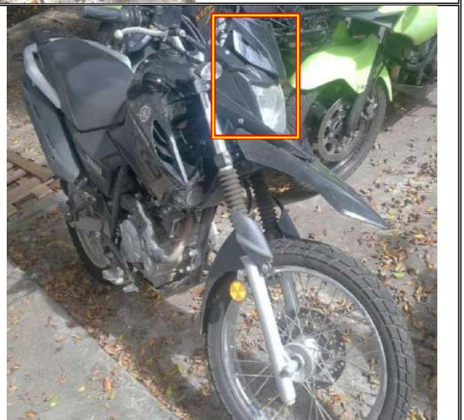
**Fotografías número 1, 2 y 3 plano medio y plano general:** En estas imágenes se observa y se resalta la parte anterior del vehículo clase MOTOCICLETA de placa JSK-92G, se evidencian daños en el segmento del guardabarros, en el segmento de la barra del sistema de suspensión
