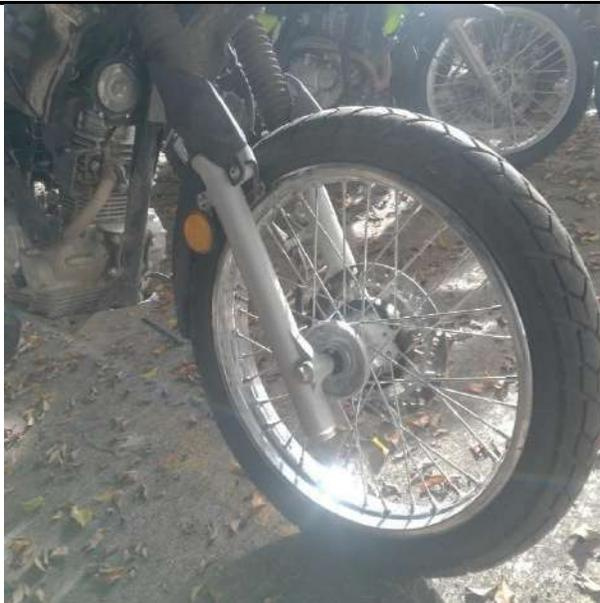
**Fotografía número 17 en primer plano:** En esta imagen se observa el sistema de suspensión anterior derecho tipo horquilla del vehículo MOTOCICLETA de placa JSK-92G: Conjunto en buen estado
