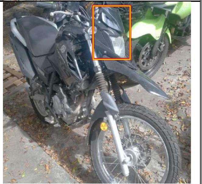
En las siguientes imágenes se observan y se resaltan todos los daños que posee el vehículo debido al accidente de tránsito presenta: rotura y rayones en el segmento del guardabarros anterior, deformación en el segmento de la barra del sistema de suspensión costado izquierdo, rotura en el conjunto del espejo izquierdo, rayones y rotura en el segmento del carenaje, rotura
