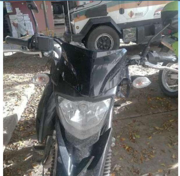
**Fotografía número 14 en primer plano:** En esta imagen se observa la parte anterior del sistema de la dirección del vehículo, MOTOCICLETA de placa JSK-92G, se aprecia rotura en el segmento del carenaje: Conjunto en mal estado.
