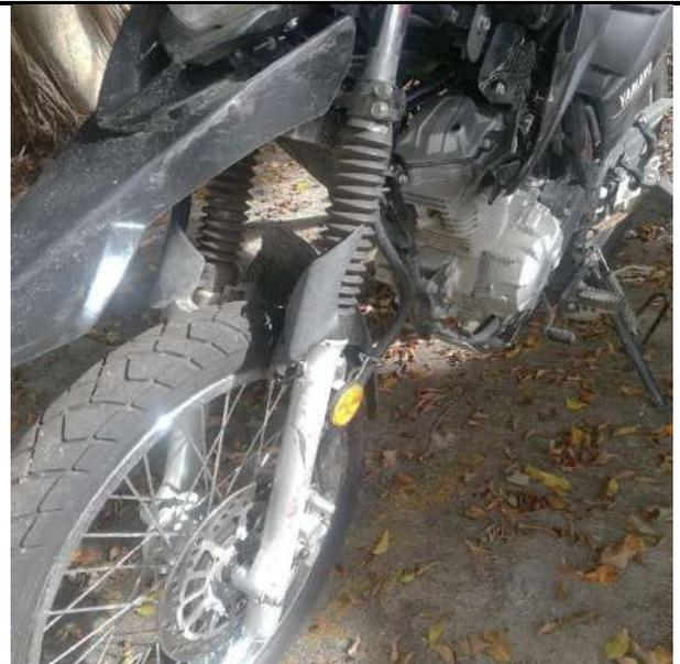
**Fotografía número 18 en primer plano:** En esta imagen se observa el sistema de suspensión anterior izquierdo tipo horquilla del vehículo MOTOCICLETA de placa JSK-92G, se aprecia deformación del componente: Conjunto en mal estado
