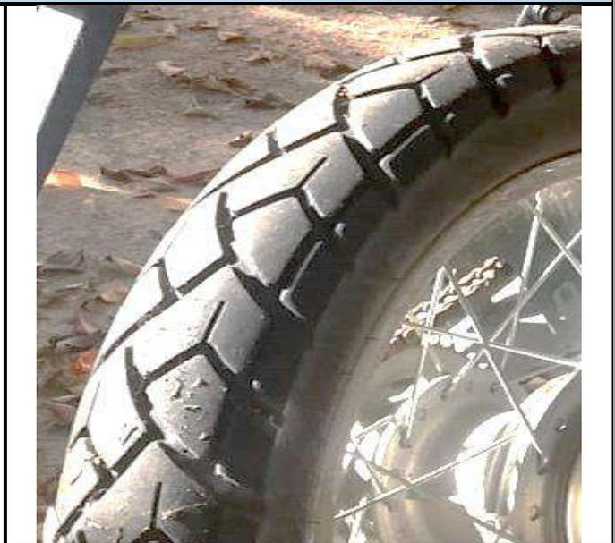
**Fotografía número 23 en primer plano:** En esta imagen se observa el labrado de la llanta posterior del vehículo MOTOCICLETA de placa JSK-92G, según el profundímetro el labrado de la llanta es de 5mm en buen estado.
