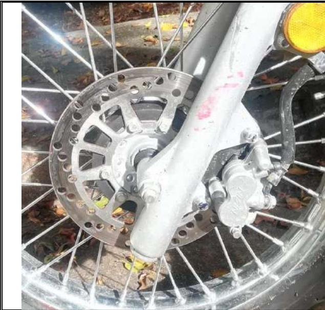
**Fotografía número 20 en primer plano:** En esta imagen se observa el sistema de frenos anterior tipo mordaza y disco del vehículo clase MOTOCICLETA de placa JSK-92G: Conjunto en buen estado.
