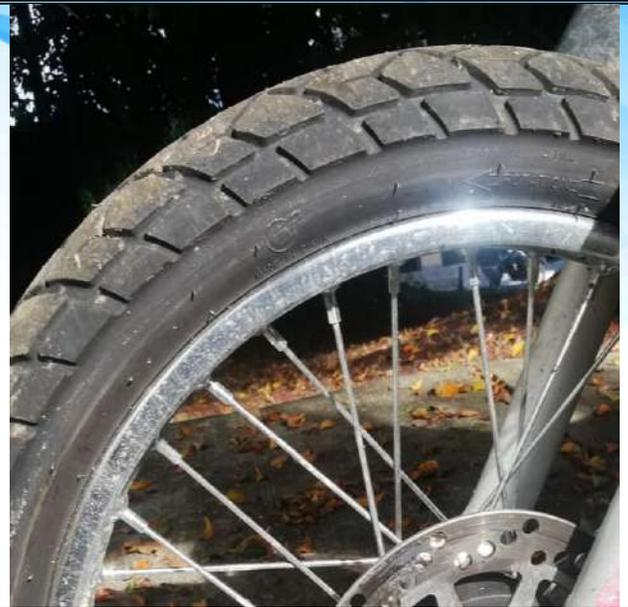
**Fotografía número 25 en primer plano:** En esta imagen se observa el labrado de la llanta anterior del vehículo clase MOTOCICLETA de placa JSK-92G, según el profundímetro el labrado de la llanta es de 5mm en buen estado.
