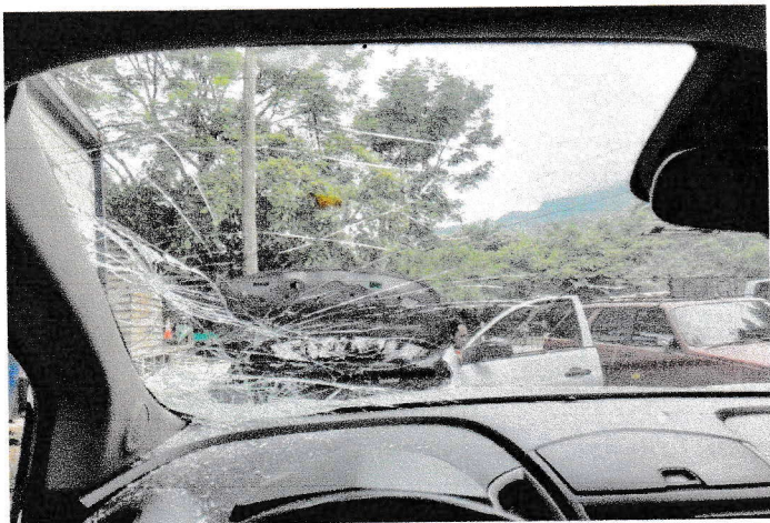
PRIMER PLANO: se observa parabrisas fuertemente fisurado debido al impacto.
