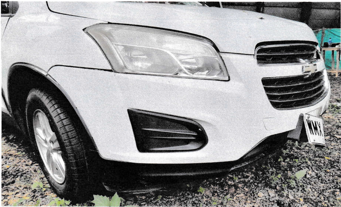
Se observa desajuste entre el parachoque lateral frontal derecha
