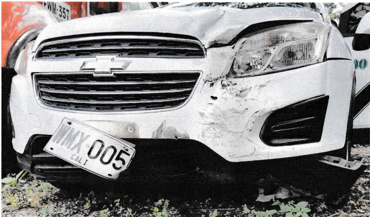
PRIMER PLANO: Se observa fuerte hundimiento en parte anterior (izquierda-inferior) del vehículo “guardafangos” con fuerte desplazamiento.
