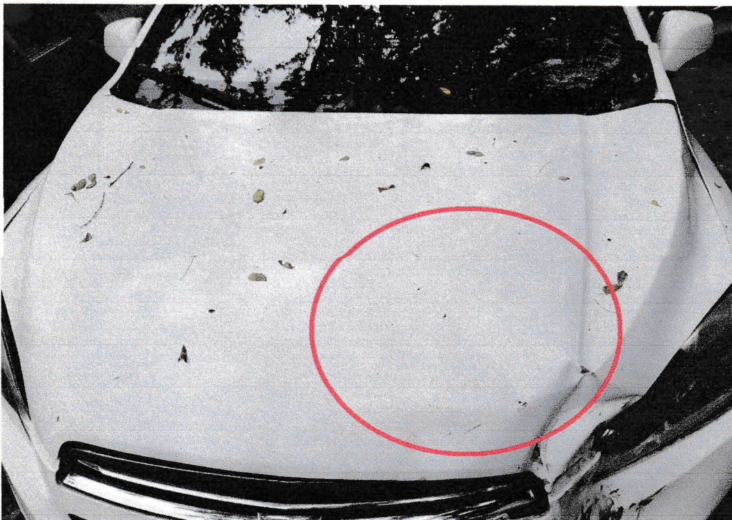
PLANO MEDIO: se observa hundimientos fuertes en la parte anterior (capo). Se evidencia guardafangos con transferencia de pintura de color amarillo.
