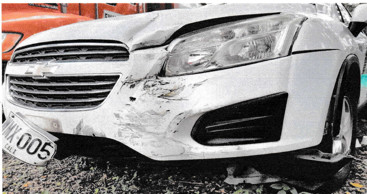
PRIMER PLANO: se observa parachoque del vehículo reventado, presenta hundimiento.
