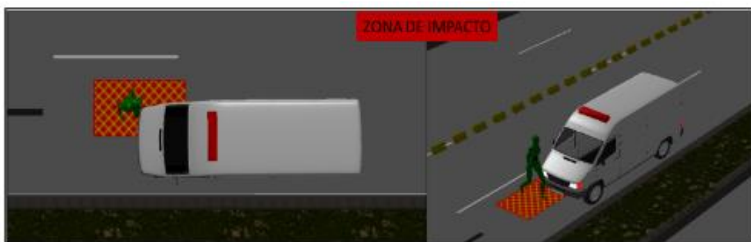
IMAGEN No.30: En esta imagen en 3D y a escala diagramado con el software de reconstrucción VISTA FX, se observa el momento del impacto, entre el vehículo No.1 (Ambulancia) y el Peatón, siendo el área de contacto para el vehículo No. 1 en su vértice anterior derecho, y el peatón es impactado en su costado lateral izquierdo.
