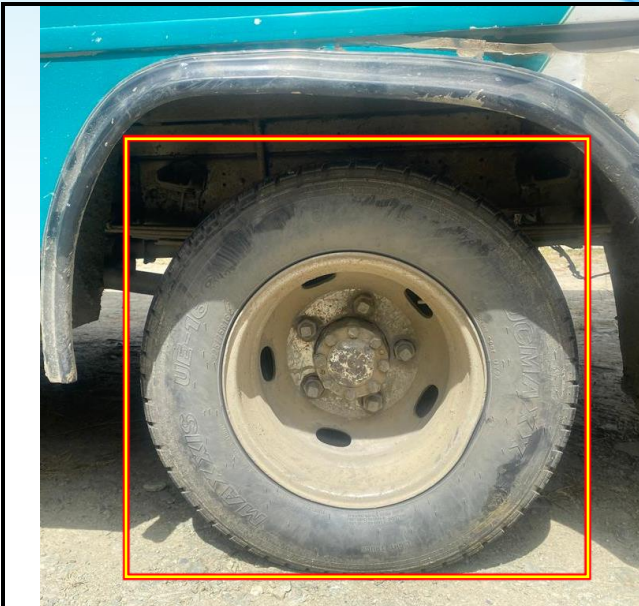
Fotografía número 33 en primer plano: En esta imagen se observa la llanta posterior izquierda del vehículo clase MICROBUS de placas TKK-610: Conjunto en buen estado.
