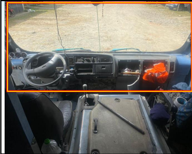
Fotografía número 15 en primer plano: En esta imagen se observa el interior del vehículo clase MICROBUS de placas TKK-610 : Presenta rotura en retrovisor anterior, presenta desajuste en la guantera: conjunto en mal estado debido al accidente de tránsito.
