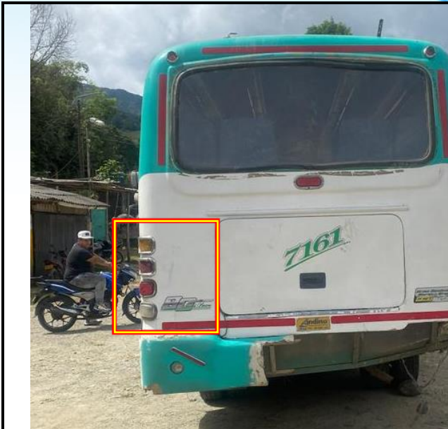
Fotografía número 13 en primer plano: en esta imagen se observa el sistema de alumbrado posterior izquierdo del vehículo clase MICROBUS de placas TKK-610 : conjunto en buen estado estructural.
