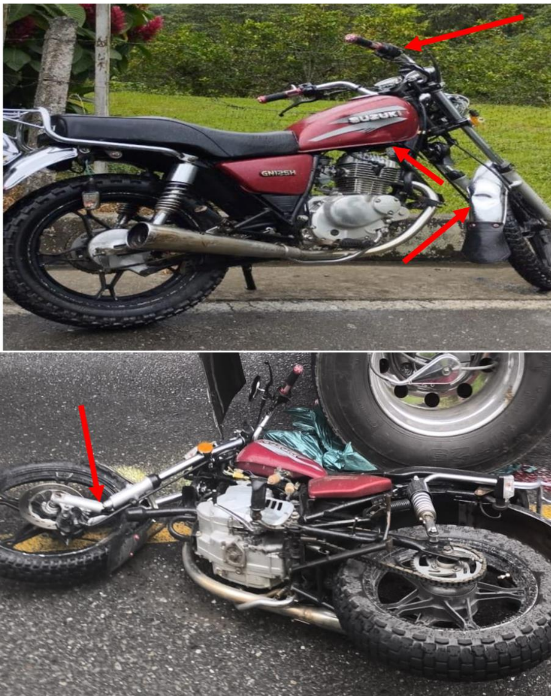
Imagen No.12: compuesta por registros del día de los hechos donde se observa parcialmente el estado final de la motocicleta, identificando daño en el eje delantero, deformación barras, doblamiento manubrio, desalojo espejo retrovisor, abolladura tanque, guardabarros con doblamiento.
