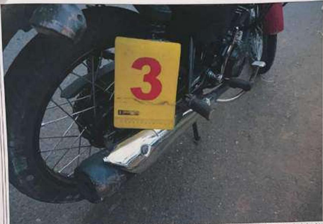
**IMAGEN No.18: PRIMER PLANO:** Fotografía judicial de verificación de daños sufridos en el siniestro la Evidencia No.3. Vehículo tipo motocicleta de placas CIG-13G observando: Abolladura en exosto.
