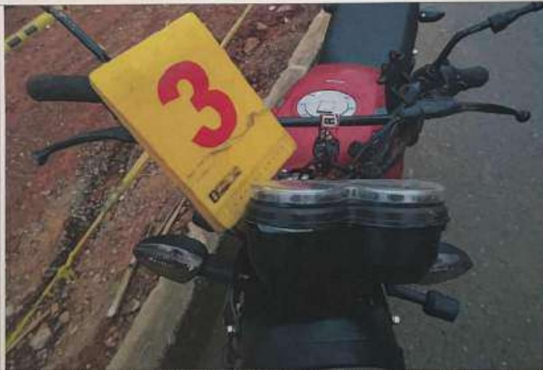
**IMAGEN No.13: PRIMER PLANO:** Fotografía judicial de verificación de daños sufridos en el siniestro la Evidencia No.3: Vehículo tipo motocicleta de placas CIG-13G observando: Ruptura en base de tacómetros.
