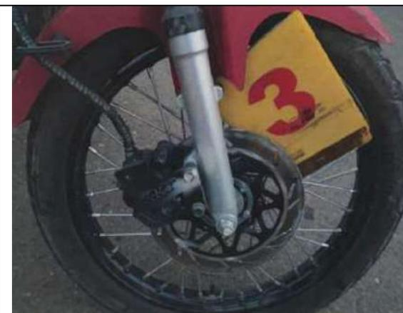
Daños por fricción en el disco delantero de freno, el cual es portado al lado derecho
