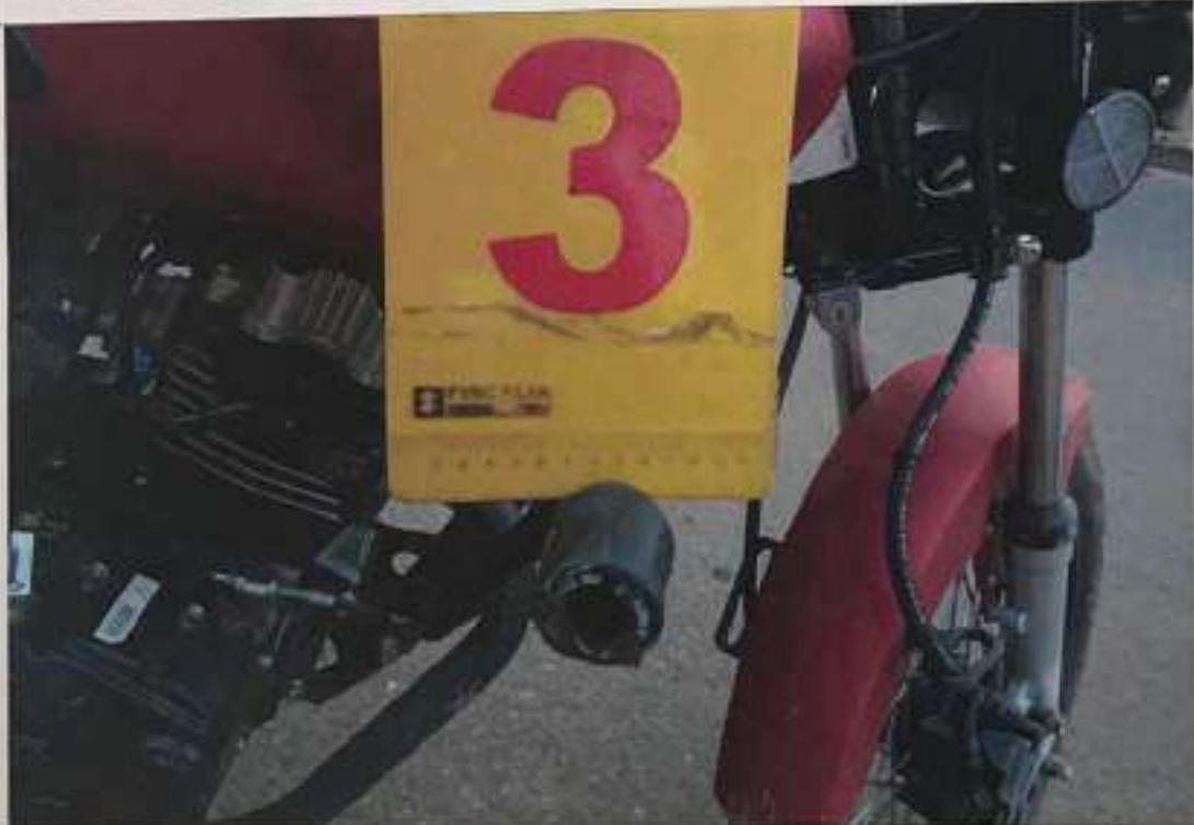
**IMAGEN No.19: PRIMER PLANO:** Fotografía judicial de verificación de daños sufridos en el siniestro la Evidencia No.3. Vehículo tipo motocicleta de placas CIG-13G observando: Abolladura en slider o barra protectora costado derecho.
