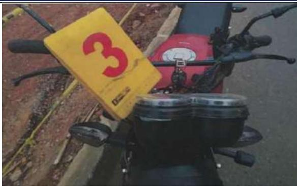
Plano frontal superior de la motocicleta donde se evidencian daños en el tacómetro y fricción en la manigueta de freno.
