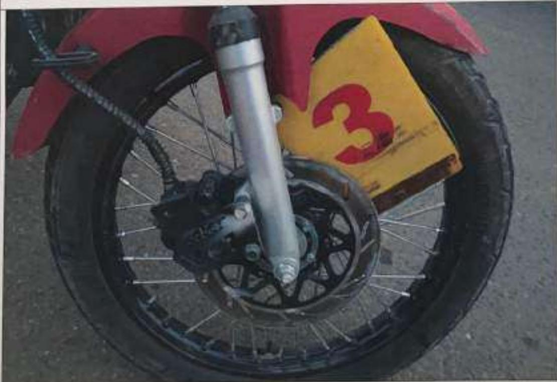
**IMAGEN No.15: PRIMER PLANO:** Fotografía judicial de verificación de daños sufridos en el siniestro la Evidencia No.3: Vehículo tipo motocicleta de placas CIG-13G observando: Abolladura en disco de freno delantero.
