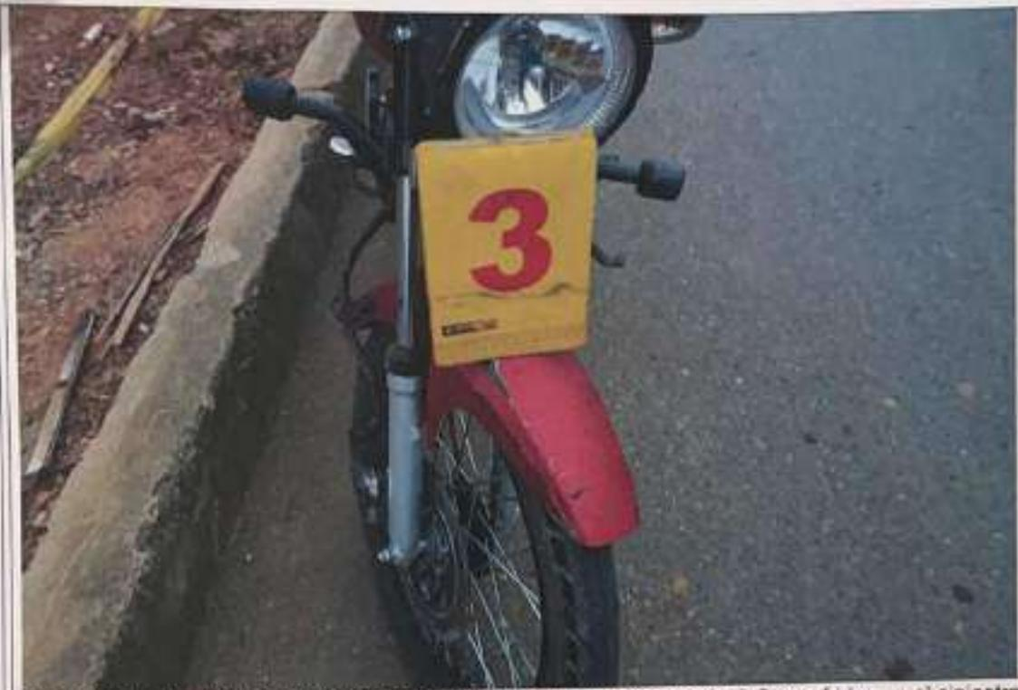
**IMAGEN No.14: PRIMER PLANO:** Fotografía judicial de verificación de daños sufridos en el siniestro la Evidencia No.3: Vehículo tipo motocicleta de placas CIG-13G observando: Abolladura en guardafango delantero en su costado derecho.
