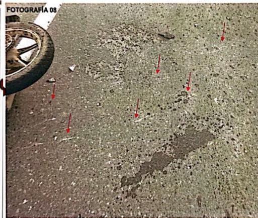
FOTOGRAFÍA 07, 08, (plano general – plano medio), se evidencia en el carril derecho sentido vial Popayán – Cali, el inicio de una huella de arrastre metálico que inicia a un costado de la doble línea horizontal longitudinal continua color amarillo que separa los carriles de circulación vehicular y finaliza en la posición final del vehículo clase motocicleta de placas ZUO56D. Se resalta mediante flechas de color rojo. Se identificó como EMP y/o EF. 2.
