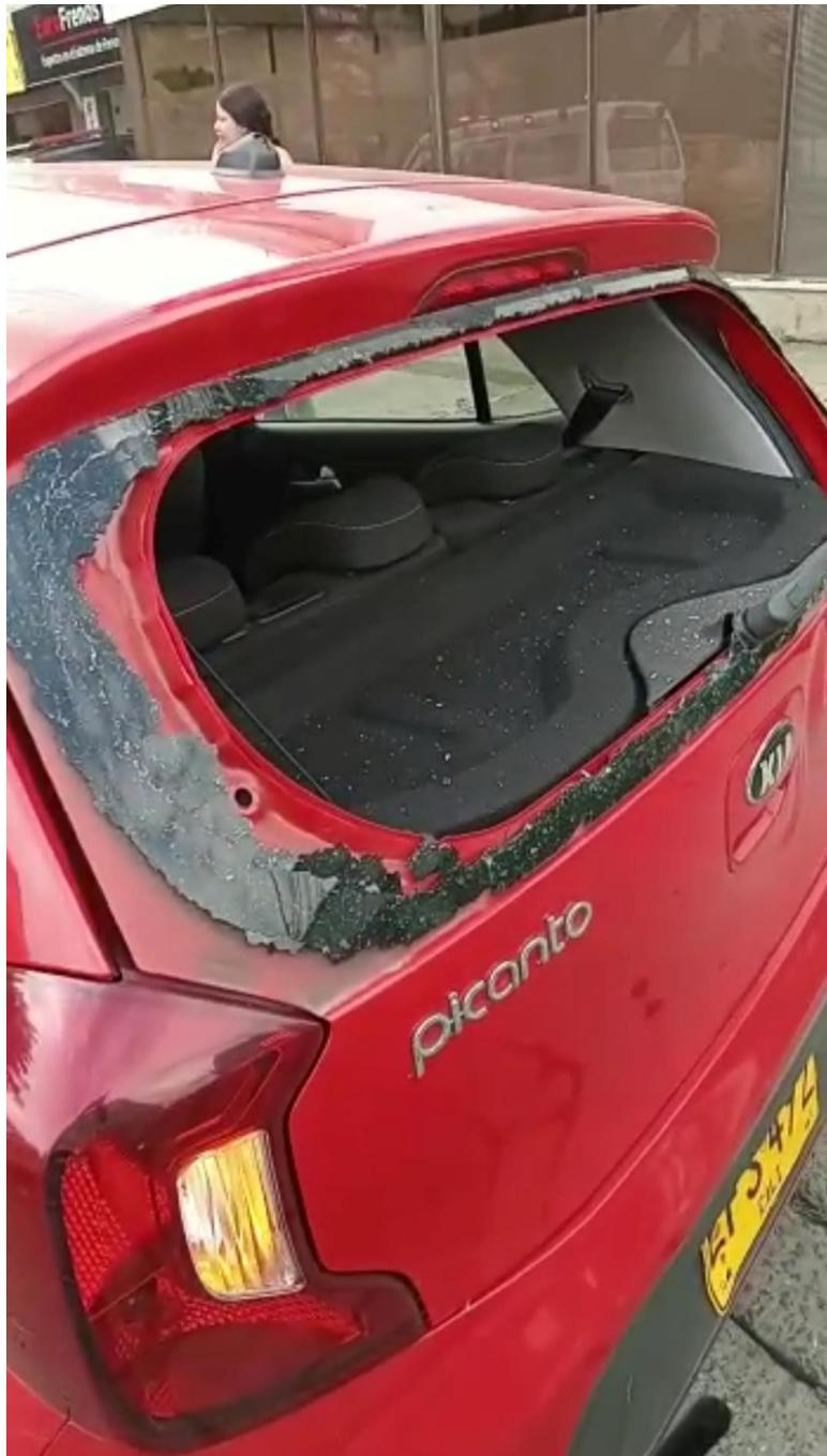
VISTA DE LA PARTE TRASERA DEL VEHICULO AFECTADO, PARABRISAS Y BUMPER Y PUERTA DE LA BODEGA EN MAL ESTADO
