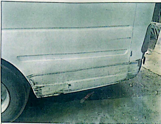
Imagen 13, se observa la nave del guardafango trasero lado izquierdo abollado en forma cóncava y convexa.
