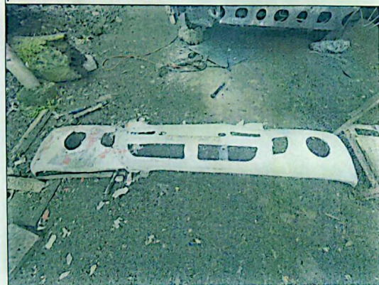
Imagen 3, se observa el bomper delantero destruido.
