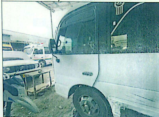
Imagen 15, se observa la puerta delantera lado izquierdo desalineada del punto de ajuste.
