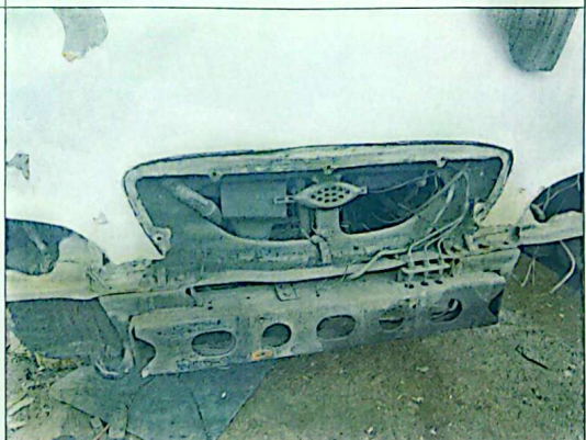
Imagen 6, se observa la persiana destruida.
