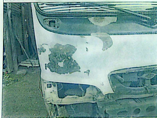
Imagen 5, se observa el torpedó externo lado derecho abollado en forma cóncava y convexa, pieza intervenida.
