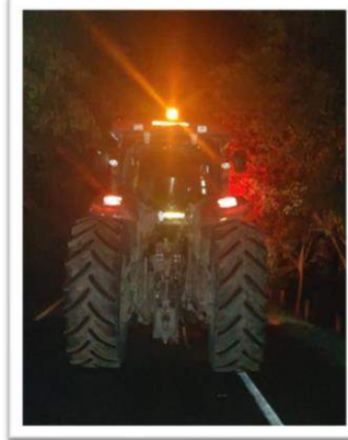
Tractor No. 25377 con iluminación y cintas reflectivas en buen estado
