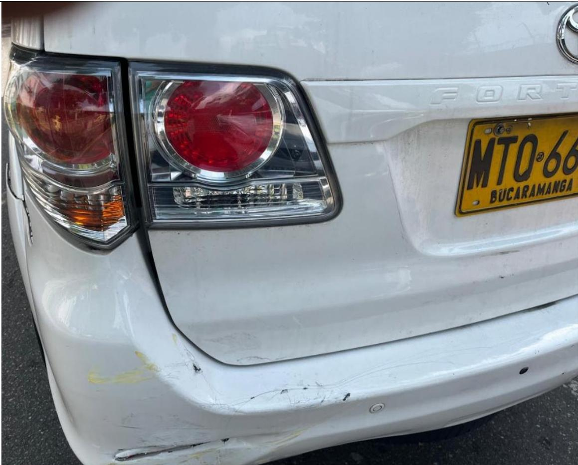
**IMAGEN 04.** Se observa abolladura del reflector trasero izquierdo, y rayones de forma horizontal de color amarillo del bómpen del vehículo de placa MTQ-660
