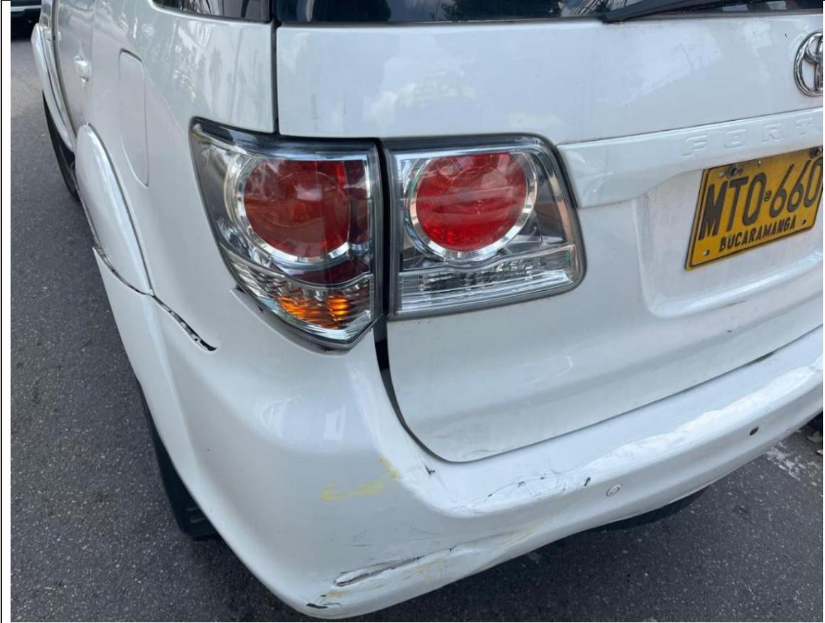
**IMAGEN 01.** Se observa el Desajuste por impacto en el vértice posterior izquierdo del para golpes (bómpen) del vehículo de placa MTQ-660
