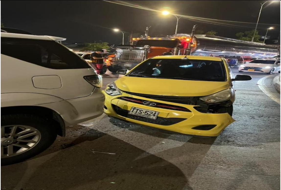
**IMAGEN 03.** Se observa el desprendimiento del paragolpes en el vértice anterior izquierdo del vehículo tipo taxi de placa TTS-524
