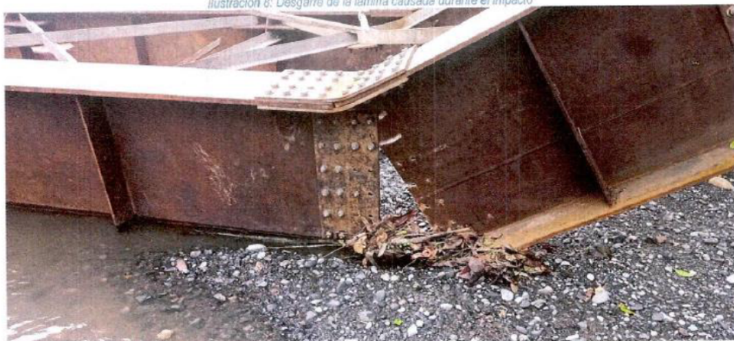
Ilustración 8: Desgarre de la lámina causada durante el impacto
