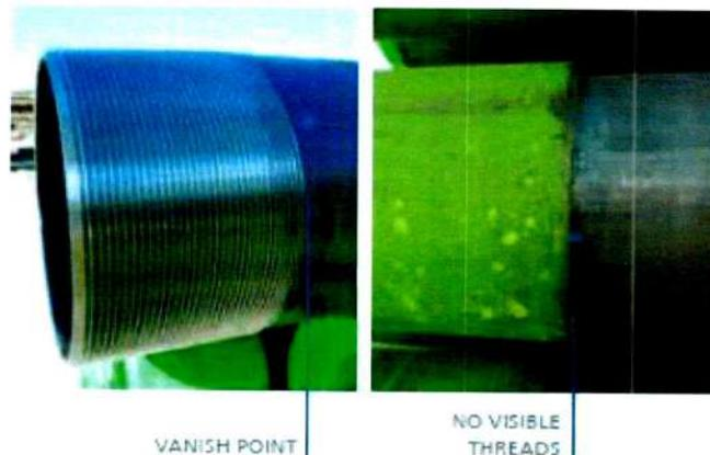
Figura 26. Ilustración del acople que debe observarse después de la aplicación del torque óptimo. No deben quedar visibles más de 2 hilos de rosca. Fuente: API 8 *round connections*. Tenaris, 2018.
