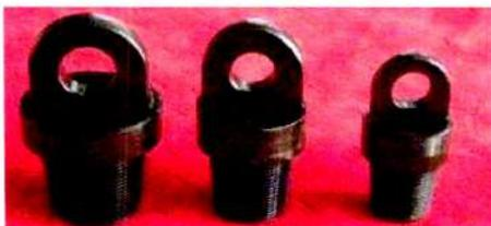
**Ayatola (Lifting Cap):** accesorio roscado en un extremo (existen de varios tipos de conexión y se conecta a al extremo de caja de un tubular) y ojo el extremo contrario (ojo o también herradura) para enganchar tubería.
