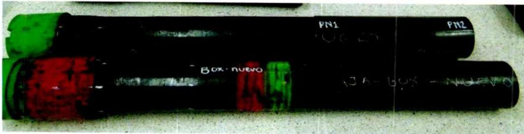
Figura 4. Secciones obtenidas para estudio. De arriba abajo: pin nuevo y tubo box nuevo.
