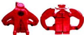
**Elevador:** Herramienta o accesorio que se acopla al Top Drive o bloque viajero por medio de los brazos y permite sujetar artículos tubulares (varilla, tubería, etc.) facilitando el sacado o bajado de la misma al pozo.
