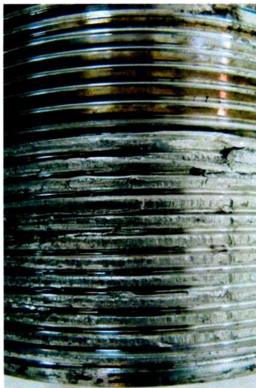
Crestas de los hilos aplanados por un movimiento rotacional y posterior deformación longitudinal durante el jump out
