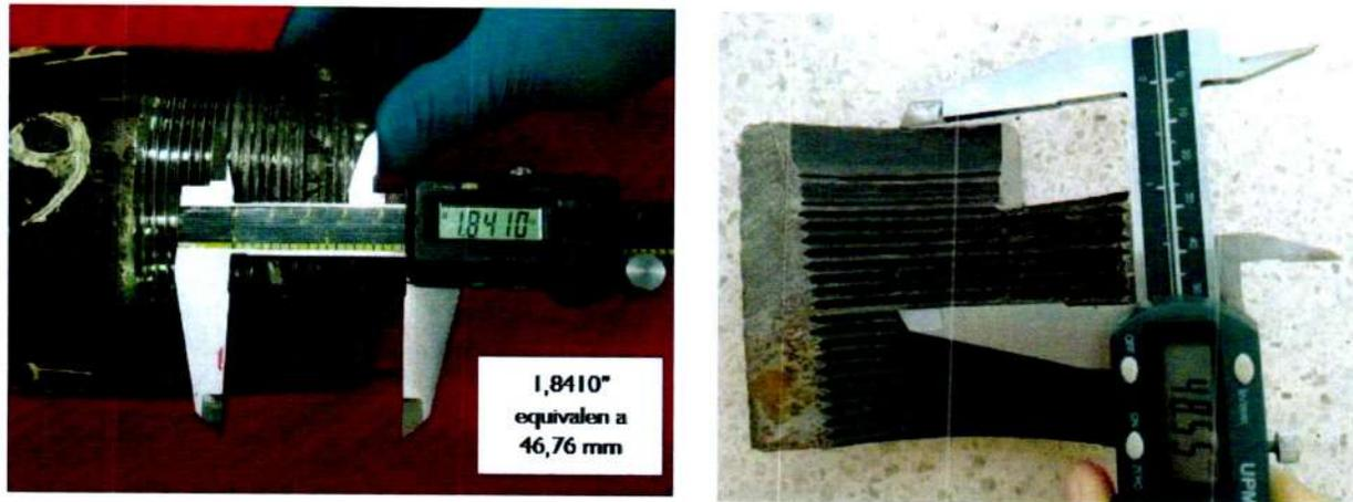
Figura 10. Zonas de daño comparables entre el pin y el coupling fallados.
