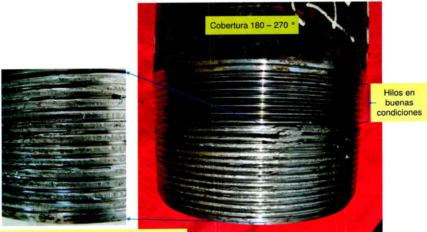
Crestas de los hilos aplanados por un movimiento rotacional y posterior deformación longitudinal durante el jump out
