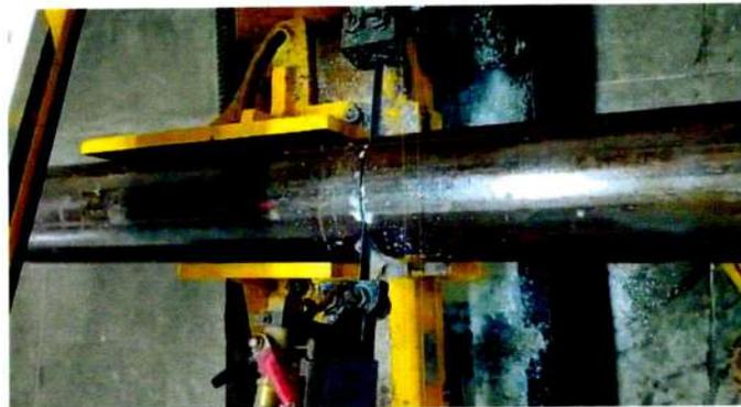
Figura 3. Corte de piezas con sierra usando como lubricante taladrina. Fuente: OFEX-EIMCM-UIS
