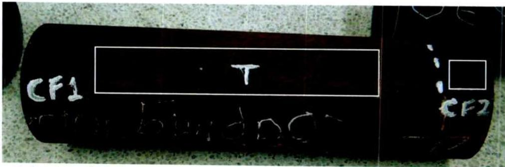
Figura 5. Secciones obtenidas para estudio en el tubo box fallado. El rectángulo marcado como T fue usado para la obtención de probetas de tracción. De la sección CF2, se obtuvieron las muestras para determinación de composición química, dureza y microestructura.
