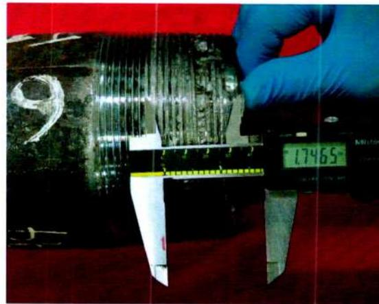
Las figuras muestran las longitudes  $L_1$  y  $L_2$ , adicionalmente la longitud de la rosca dañada.
