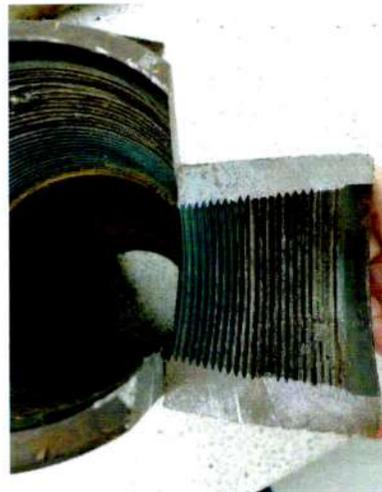
**Figura 6.** Secuencia de cortes realizados en el coupling fallado. En la fotografía superior central se observa la secuencia del corte de acuerdo con las líneas, en la fotografía inferior izquierda se presenta la vista frontal del coupling antes de ser cortado. La fotografía inferior derecha muestra la sección retirada del coupling para análisis de la superficie deformada durante la falla. Fuente: OFEX-EIMCM-UIS
