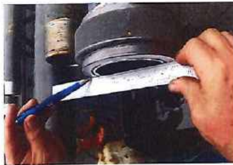
Foto No. 8 Variación en el Paralelismo de la Conexión respecto a la cara plana del Working Gage
