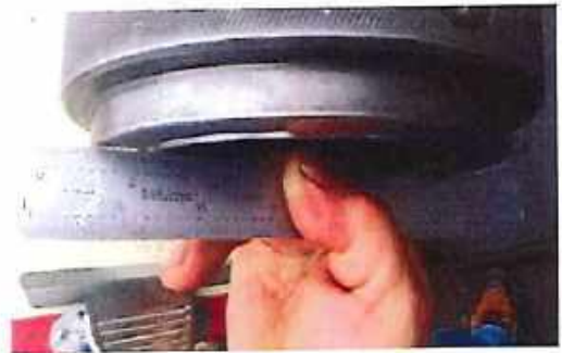
Foto No. 8 Variación en el Paralelismo de la Conexión respecto a la cara plana del Working Gage
