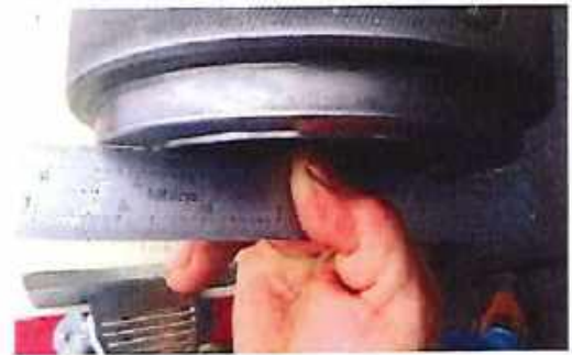
Foto No. 7 Variación en el Paralelismo de la Conexión respecto a la cara plana del Working Gage
