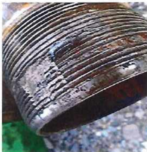
Foto No. 8 Conexión 4 ½ EU Pin de Junta No. 20 que se saltó
