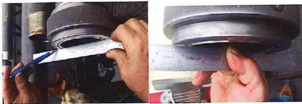
Variación en el Paralelismo de la Conexión respecto a la cara plana del Working Gage
