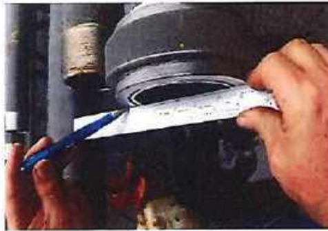
Foto No. 7 Variación en el Paralelismo de la Conexión respecto a la cara plana del Working Gage
