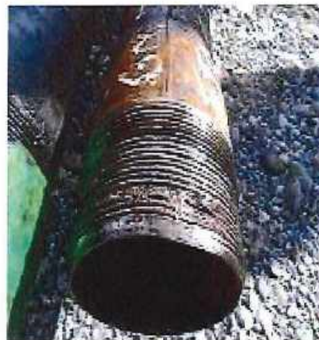
Foto No. 8 Conexión 4 ½ EU Pin de Junta No. 20 que se saltó
