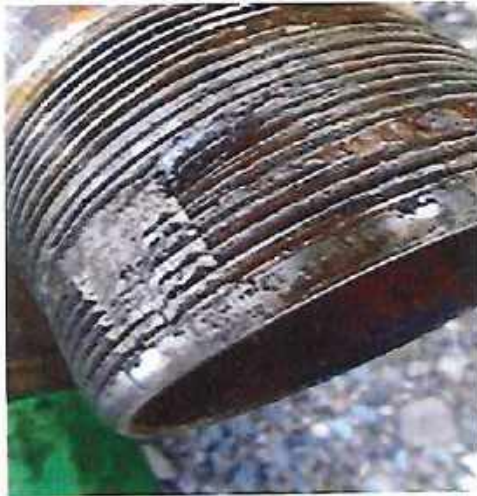
Foto No. 1 Conexión 4 ½ EU Pin de Junta No. 20 que se soltó
