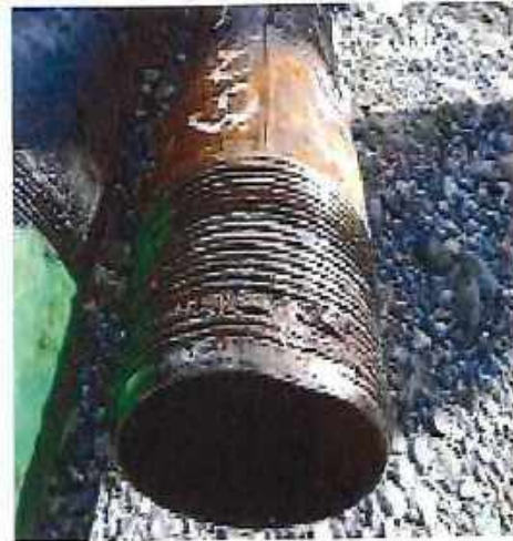
Foto No. 1 Conexión 4 ½ EU Pin de Junta No. 20 que se soltó
